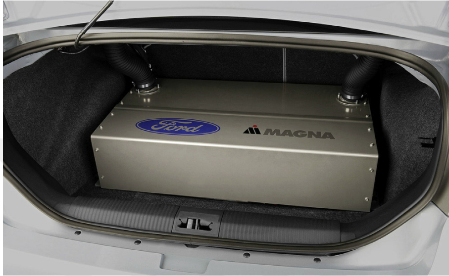
Şekil 1.3. Elektrikli Ford Focus'un 23 kWh'lik Li-ion batarya paketi [1].
