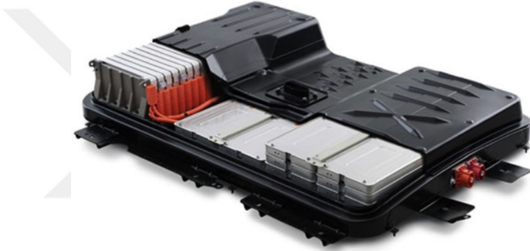
Şekil 1.1. Nissan Leaf’in 24 kWh’lik Li-ion batarya paketi [23].
