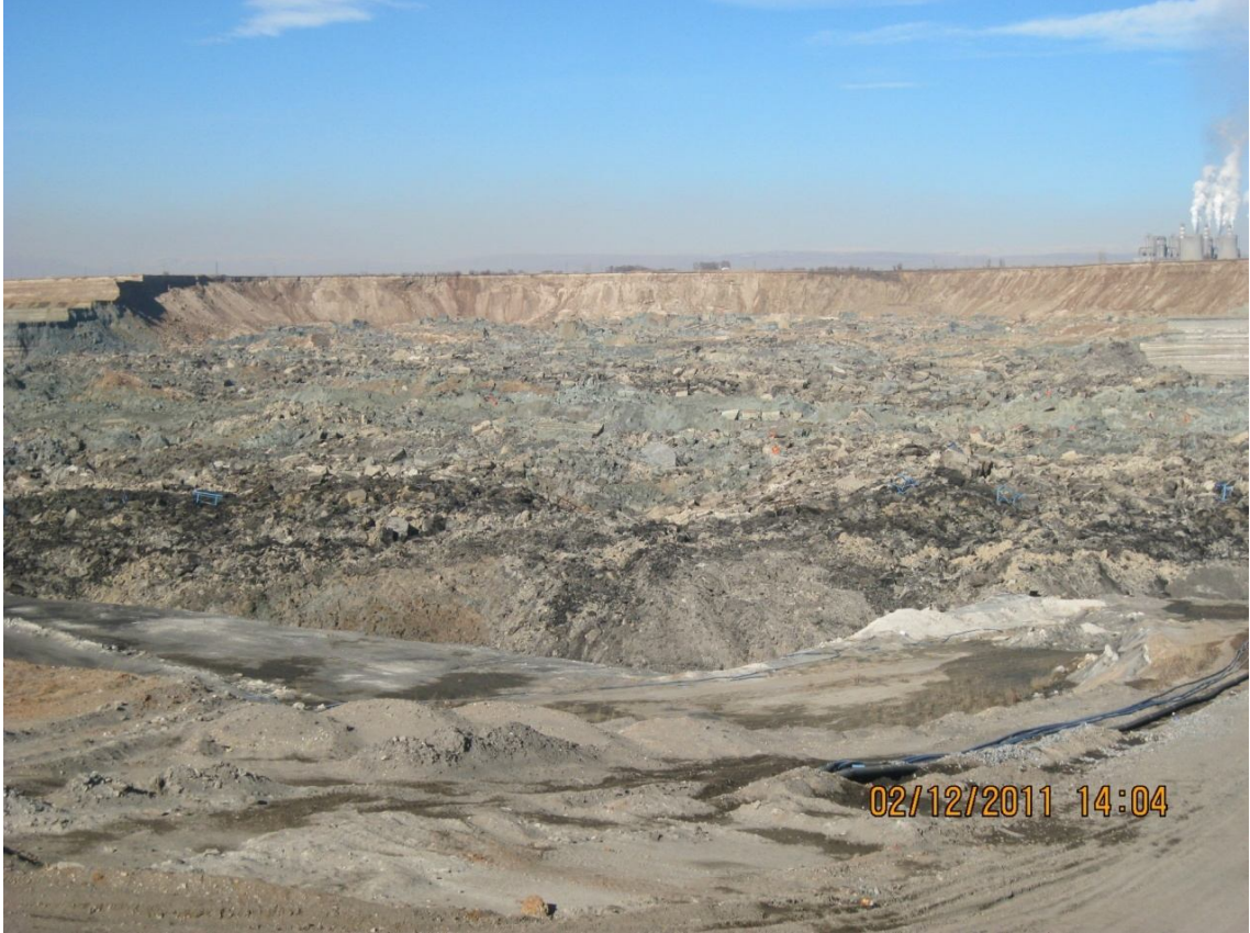
Foto 87. Çöllolar açık kömür işletmesinde meydana gelen heyelanda kayan malzeme.
