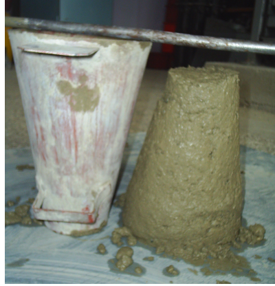
Şekil 5.2 Normal betonu için çökme deneyi
