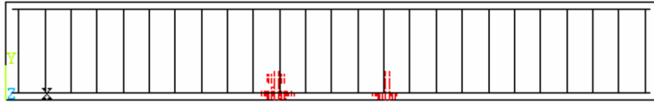
Şekil 6.18 K.KYB.20 kirişinin nümerik çözümlerinden elde edilen ilk çatlak durumu.
