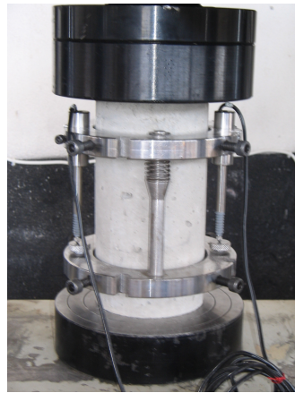
Şekil 5.6 Betonların elastisite modülü tayini
