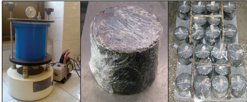
Şekil 3.10. Piknometre ve vakum cihazı, numunelerin koşullandırma işlemi için hazırlanması
