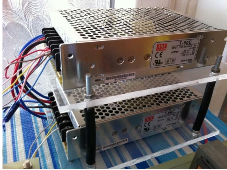
Şekil 6.8. Akım ve gerilim algılayıcıları için +/-15V sağlayan anahtarlamalı güç kaynağı
