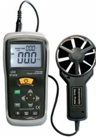
Şekil 2.7. Deneylerde kullanılan anemometrenin önden görünümü
