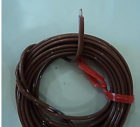
Şekil 2.8. Isıl çift (Cu-Co) uçlarının lehimlenmiş görünümü
