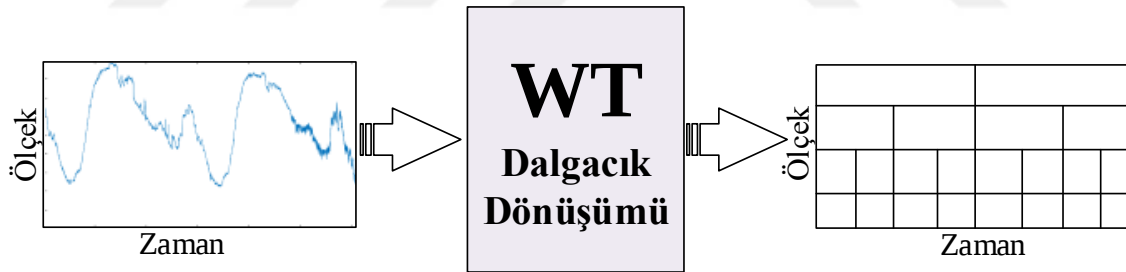
Şekil 4.3: Dalgacık dönüşümü blok şeması
