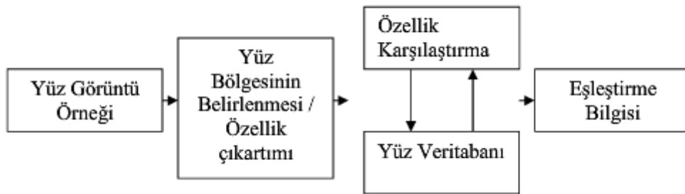
Şekil 14. Yüz tanıma sistemi blok diyagramı
