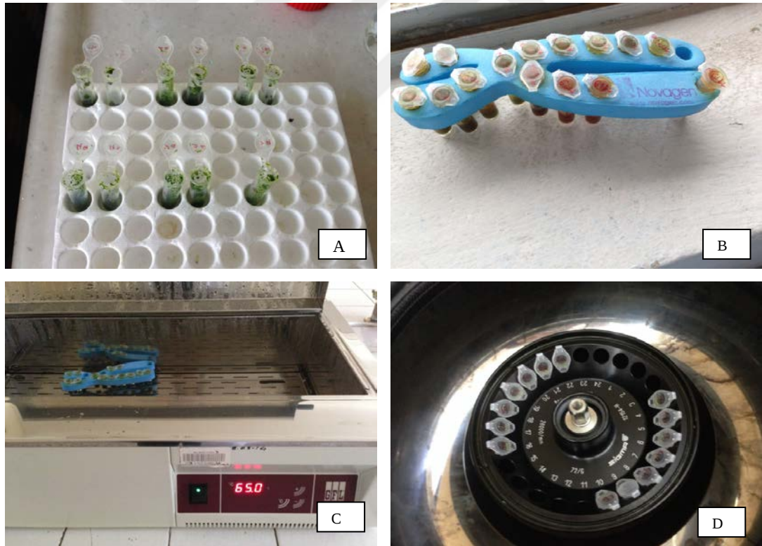
Şekil 2.3. DNA izolasyonundan görüntüler A. Toz haline getirilmiş bitki örneklerinin CTAB çözeltisi ile vortekslenmiş hali B. \beta -Merkaptoetanol eklenen tüplerin su banyosuna gitmek için hazırlanması C. 65C°'lik su banyosundan bir görüntü D. Su banyosundan çıkan tüplerin santrifüjlenmesi
