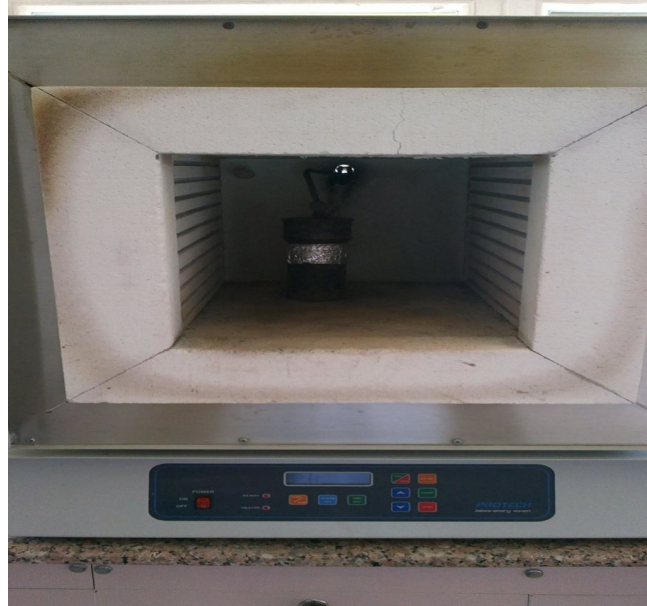
Şekil 5.1. Piroliz işleminin yapıldığı düzenek
