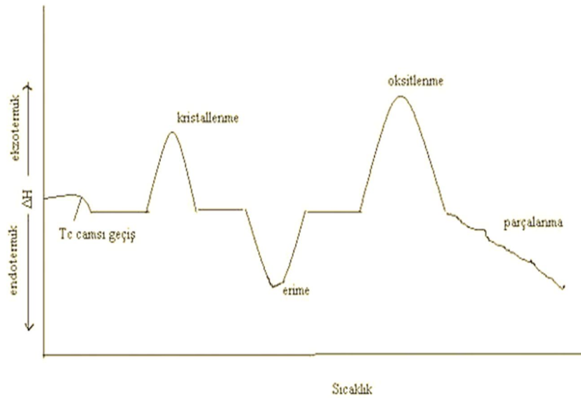
řekil 2.7. Bir polimerin bozunma ısılarına kadar ısıtıldığı termogram
