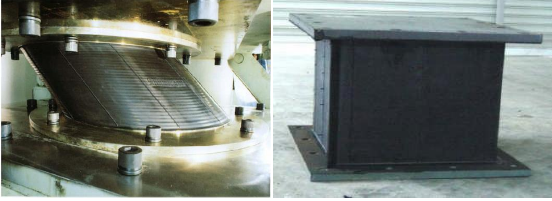
Şekil 3.2. Kauçuk esaslı sismik izolatör ve laboratuvar ortamında yük deneyi
