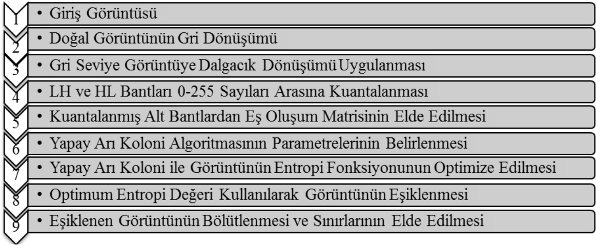
Şekil 4.3. Geliştirilen bölütleme yönteminin akış şeması.
