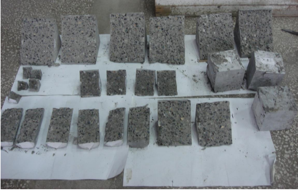
Şekil 5.11. Diyagonal yarma boyut etkisi deneyinde kırılmış numuneler
