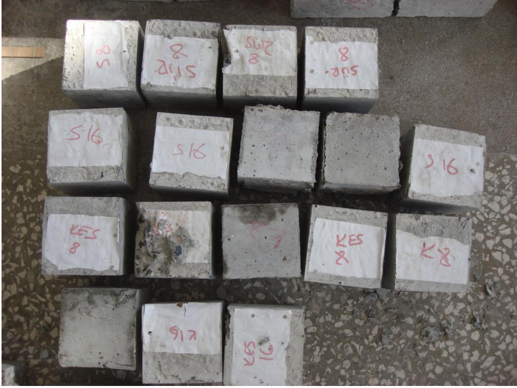
Şekil 5.27. 100x100x100 mm 3 'lük küp basınç numunelerinin kırım sonrası görünümü
