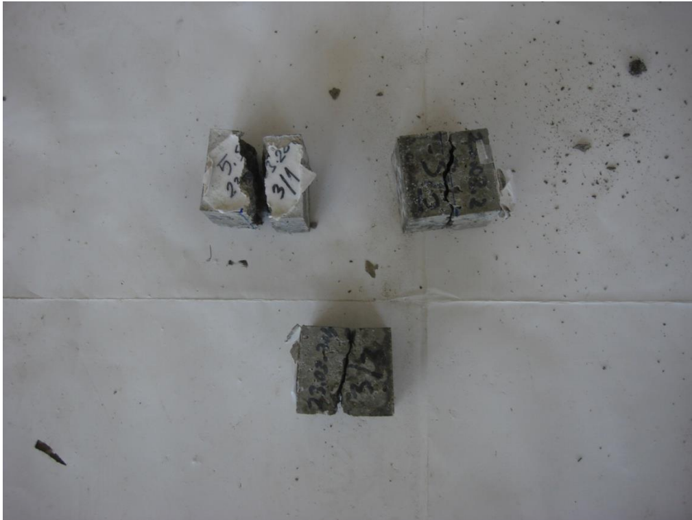
Şekil 5.8. Kenar yarma boyut etkisi deneyinde d=50 mm'lik küplerin kırılma şekilleri ve detayları
