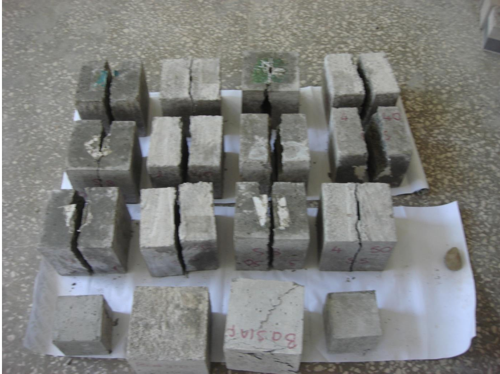
Şekil 5.17. Çentikli küp kenar yarma deneyinde d=150 mm'lik küplerin kırımdan sonraki görünümü
