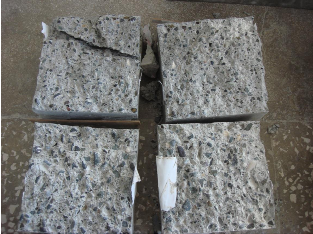
Şekil 5.28. 150x150x150 mm 3 'lük küp yarma numunelerinin kırım sonrası görünümü
