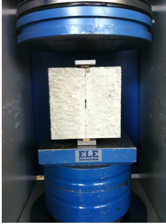
Şekil 5.16. Kenar yarmaya göre hazırlanmış numunelerin test cihazına yerleştirilmesi
