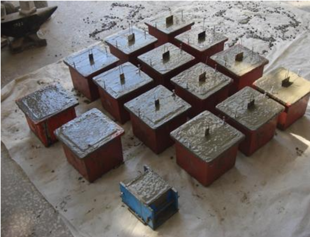
Şekil 5.15. Çentikli küp kenar yarma deneyinde kalıpların dökümden sonraki görünümü
