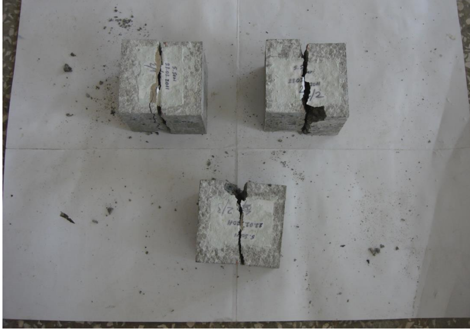
Şekil 5.7. Kenar yarma boyut etkisi deneyinde d=100 mm'lik küplerin kırılma şekilleri ve detayları
