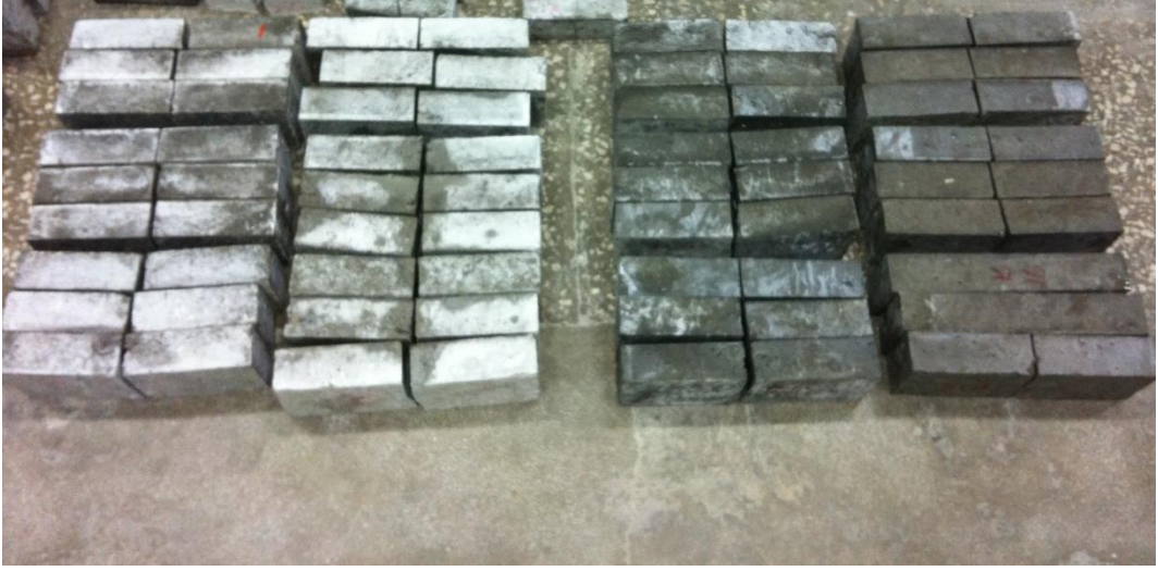
Şekil 5.25. 50x100x300 mm 3 'lük kiriş numunelerinin kırım sonrası görünümü
