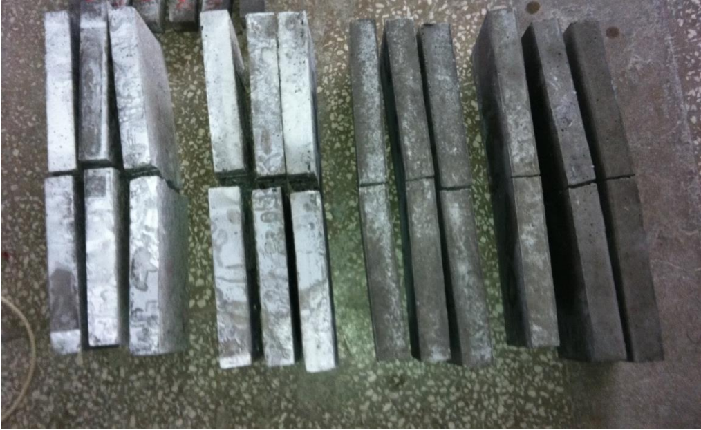
Şekil 5.24. 50x200x600 mm 3 'lük kiriş numunelerinin kırım sonrası görünümü
