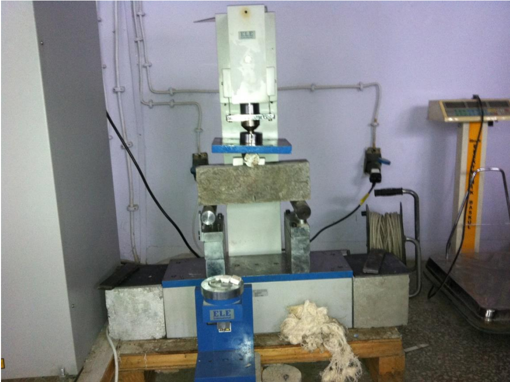
Şekil 5.22. 50x100x300 mm 3 'lük kiriş numunesinin deney düzeneği
