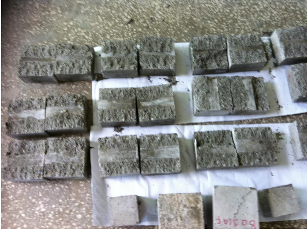
Şekil 5.18. Çentikli küp kenar yarma deneyinde d=150 mm'lik küplerin kırılma şekilleri ve detayları
