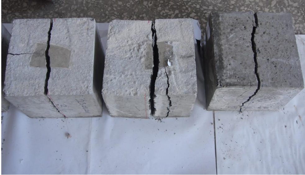
Şekil 5.6. Kenar yarma boyut etkisi deneyinde d=200 mm'lik küplerin kırılma şekilleri ve detayları
