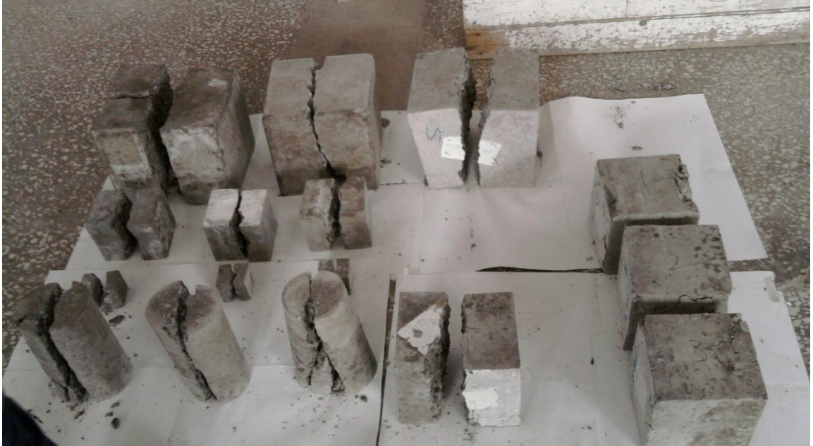
Şekil 5.4. Kenar yarma boyut etkisi deneyine ait numunelerin kırılma şekilleri ve detayları
