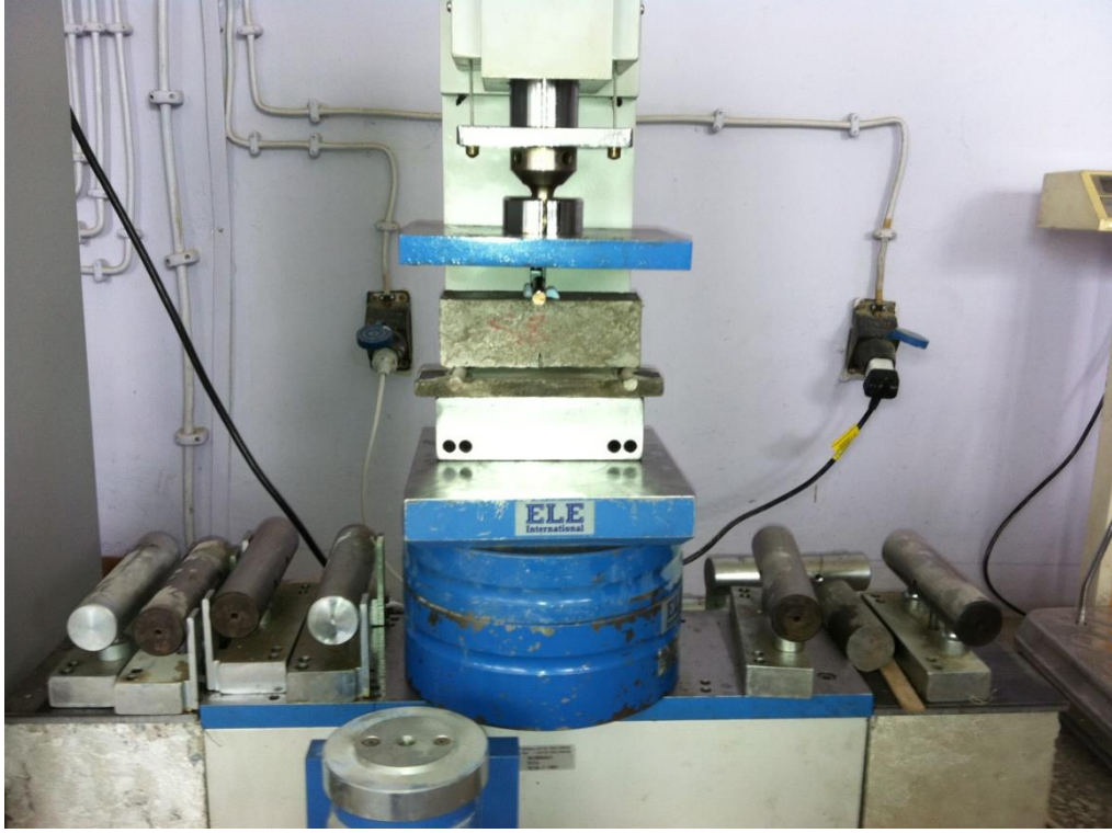
Şekil 5.23. 50x50x150 mm 3 'lik kiriş numunesinin deney düzeneği
