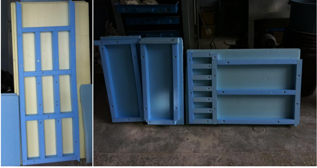
Şekil 5.19. a) 50x100x300 mm 3 'lük kiriş kalıpları b) 50x50x150 mm 3 ve 50x200x600 mm 3 'lük kiriş kalıpları
