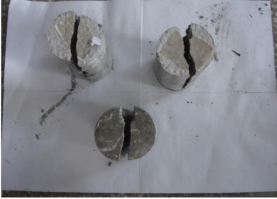
Şekil 5.9. Silindir yarma deneyinde numunelerin kırılma şekilleri ve detayları
