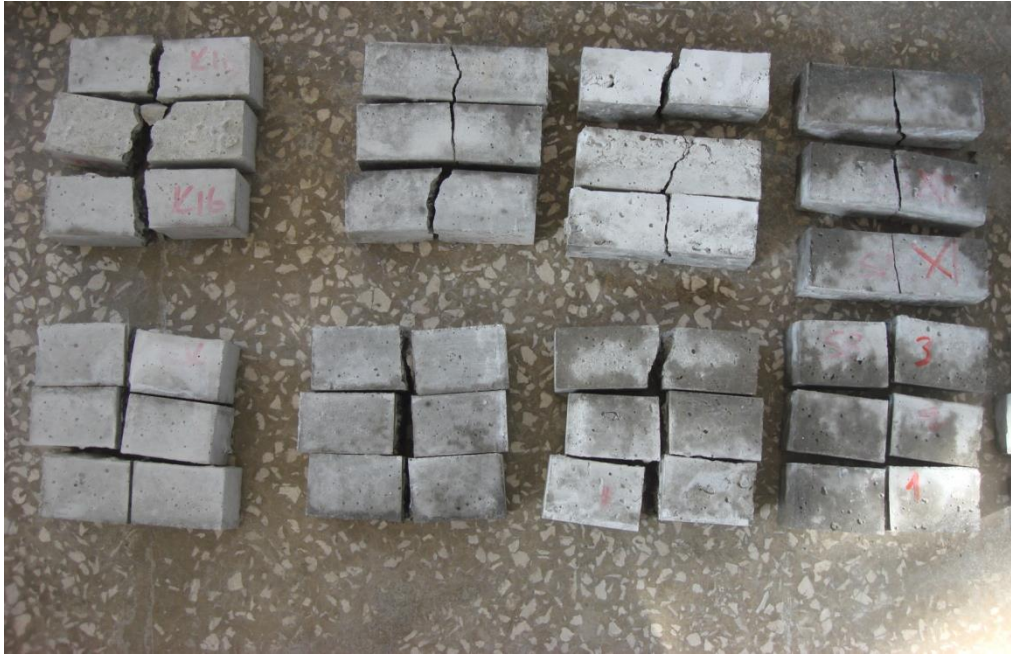
Şekil 5.26. 50x50x150 mm 3 'lük kiriş numunelerinin kırım sonrası görünümü
