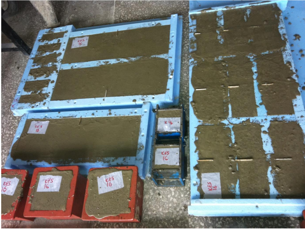
Şekil 5.20. Beton dökümü sonrası kiriş kalıpların görünümü
