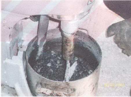
Resim 5 : Agregaya ile Bitümün Karıştırılması
