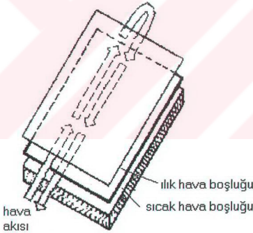
Şekil 5.11 Zıt Yönlü, İki Akışlı Hava Kollektörü Şekil 5.12 Aynı Yönlü, İki Akışlı Hava Kollektörü [79]
