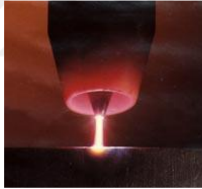
Şekil 4.2. Plazma Transfer ark kaynak nozulu [25-30]
