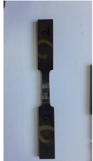
Şekil 8.13. Çekme test numunesi ölçüleri ve çekme numunesi( TSE 138 EN 10002-1).
