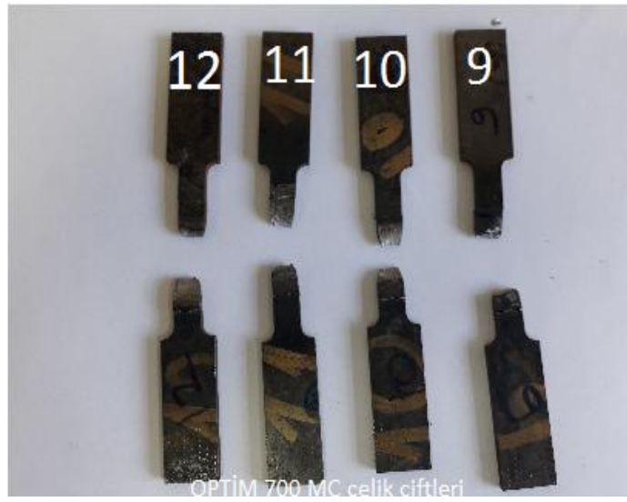
Şekil 9.19. 9-10-11-12 nolu numunelerin çekme deneyi sonra
