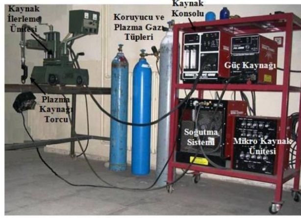
Şekil 8.2. Fırat Üniversitesi Teknoloji Fakültesi Thermal Dynamic/Arc PTA kaynak makinesi
