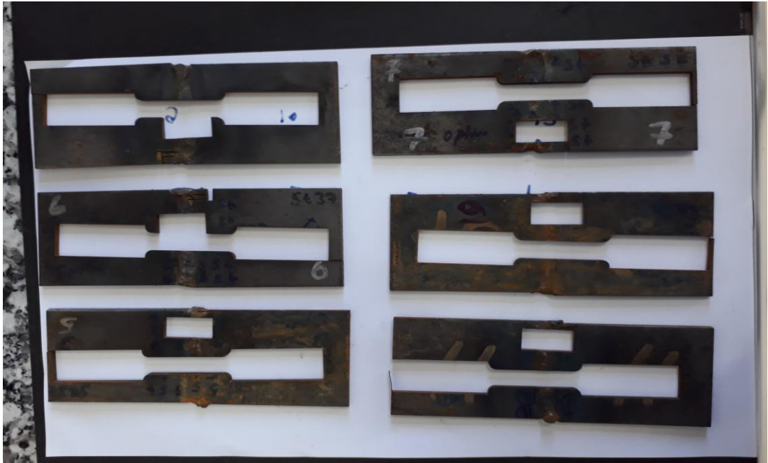
Şekil 8.11. Telerezyon kesim sonrasındaki numune boşlukları.
