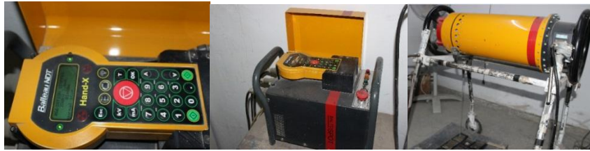
Şekil 8.4. Radyografik muayenede kullanılan Kontrol paneli, Güç kaynağı ve Işınım cihazı
