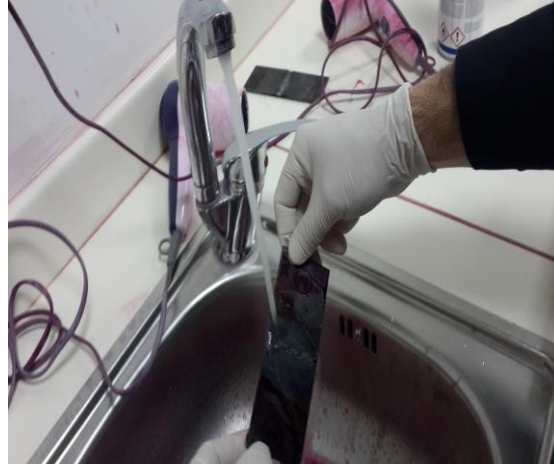
Şekil 8.7. Fazla penetrantın yüzeyden uzaklaştırılması
