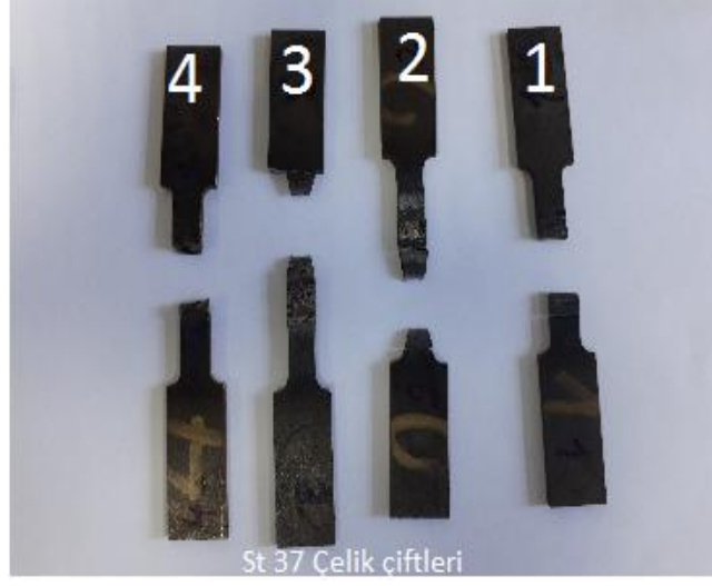
Şekil 9.17. 1-2-3-4 nolu numunelerin çekme deneyi sonra
