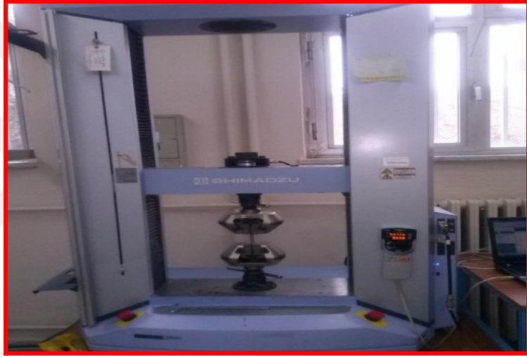
Şekil 8.12. Çekme test cihazı
