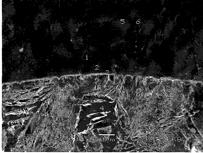
Düşük karbonlu çelik No 2 Stellite 1 TIG
