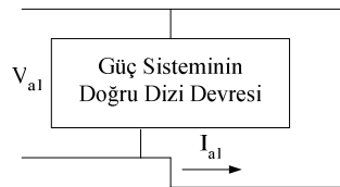
Şekil 4.34 Üç faz kısa devresi için arıza devresi
