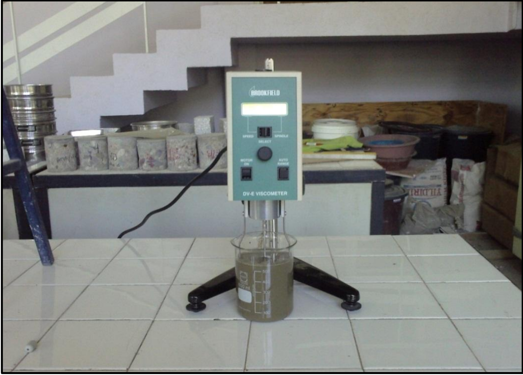
Şekil 3.7. Harcın viskozite özelliklerinin ölçümü
