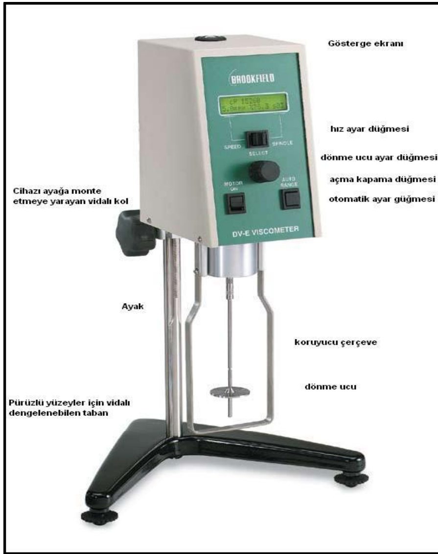
Şekil 3.6. BROOKFIELD DV-E viskozimetre deney aleti
