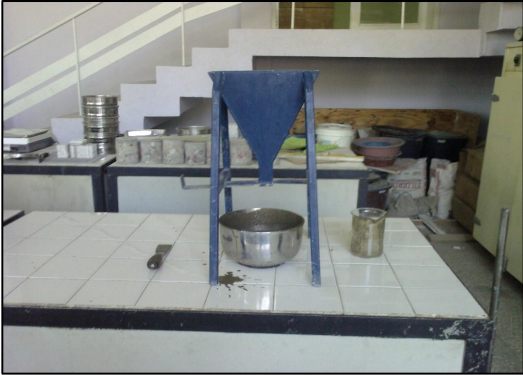
Şekil 3.5. Harcın EFNARC 2002 standartlarına uygun V-hunisi ölçümü
