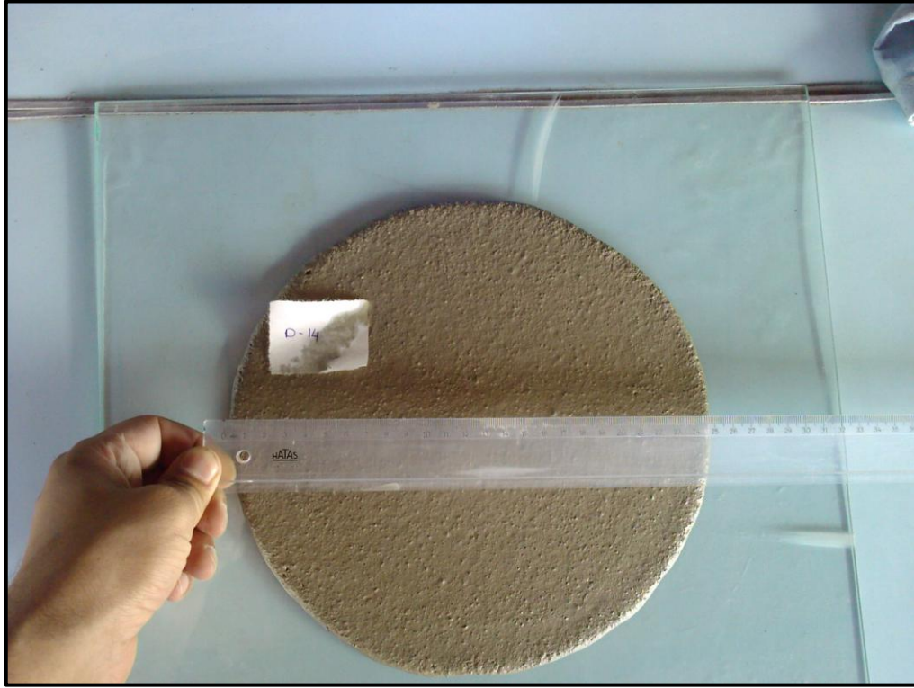
Şekil 3.3. 50C20UK30KT karışım oranlı harcın EFNARC sınırlarına göre mini çökme ölçümü
