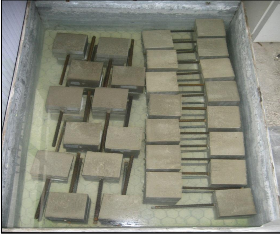
Şekil 3.18. Aderans deneyi numunelerinin uygun kür şartlarında saklanması
