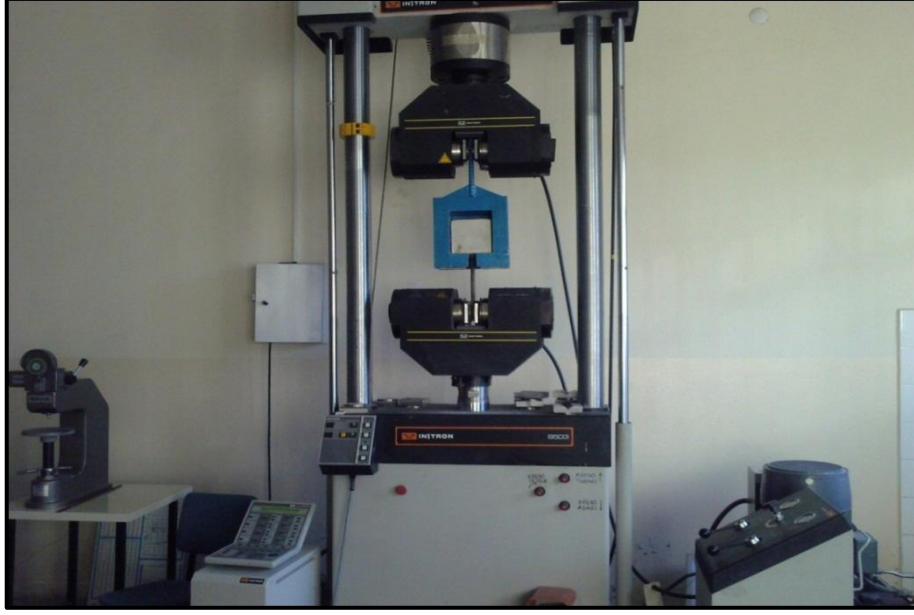
Şekil 3.19. Aderans deney düzeneğinde çekip-çıkarma (pull-out) deneyi uygulaması
