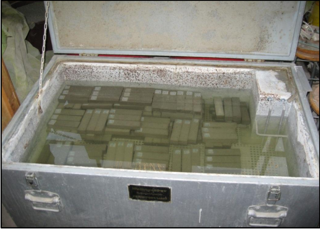
Şekil 3.9. Basınç ve çekme dayanımı deneyleri için hazırlanan numunelerin uygun kür şartlarında saklanması
