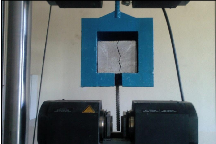
Şekil 3.20. Harcın aderans deney sonunda deforme olması
