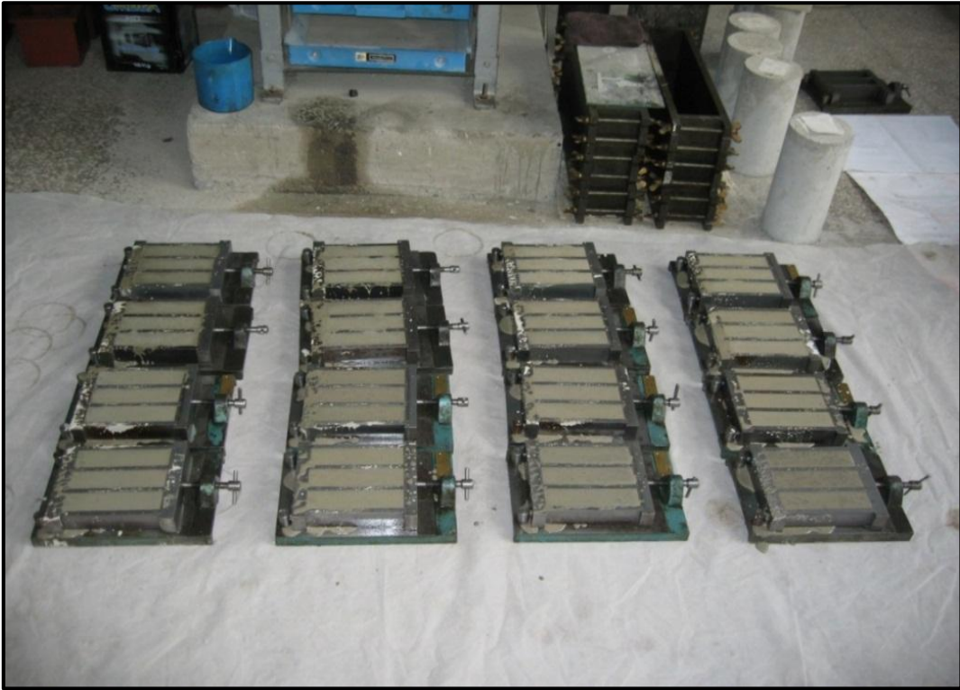
Şekil 3.8. Basınç ve çekme dayanımı deneyleri için harcın kalıblara dökümü
