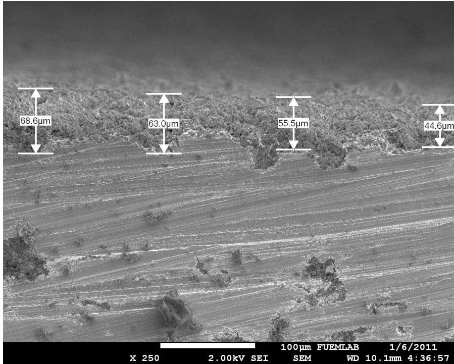
Şekil 2.17. ~60µm kalınlığında yüzey filmi oluşan mikro boyutta (~35µm) HA kaplı Mg alaşımı numunenin SEM’de kaplama kalınlığının tayini
