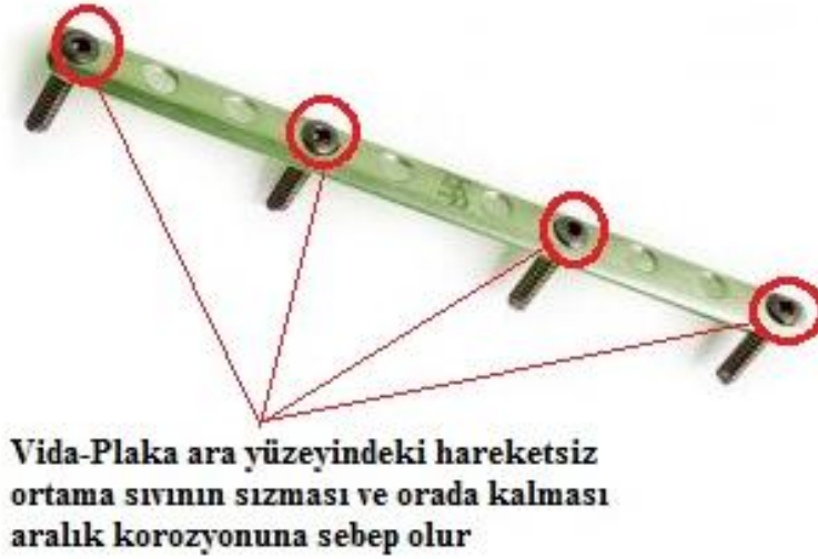
Şekil 1.5. Vida-Plaka bağlantıları arasında oluşan aralık korozyonu
