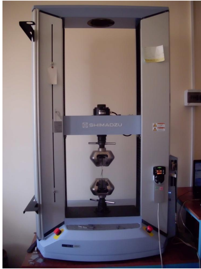
Şekil 2.31. Çekme cihazı (SHIMADZU SFL 50KNAG)
