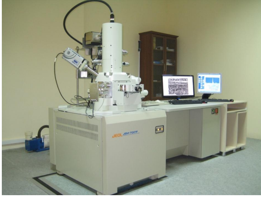
Şekil 2.33. Taramalı elektron mikroskobu (SEM) (JEOL JSM 7001 FE-SEM)
