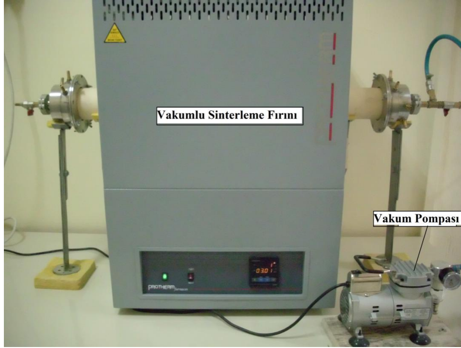
Şekil 2.20. Vakumlu sinterleme fırını (PROTHERM PC 442 PTF 17/75/200)
