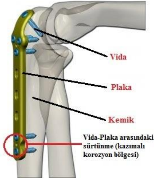
Şekil 1.9. Vida-Plaka bağlantılarında meydana gelebilen kazımalı korozyon (fretting)
