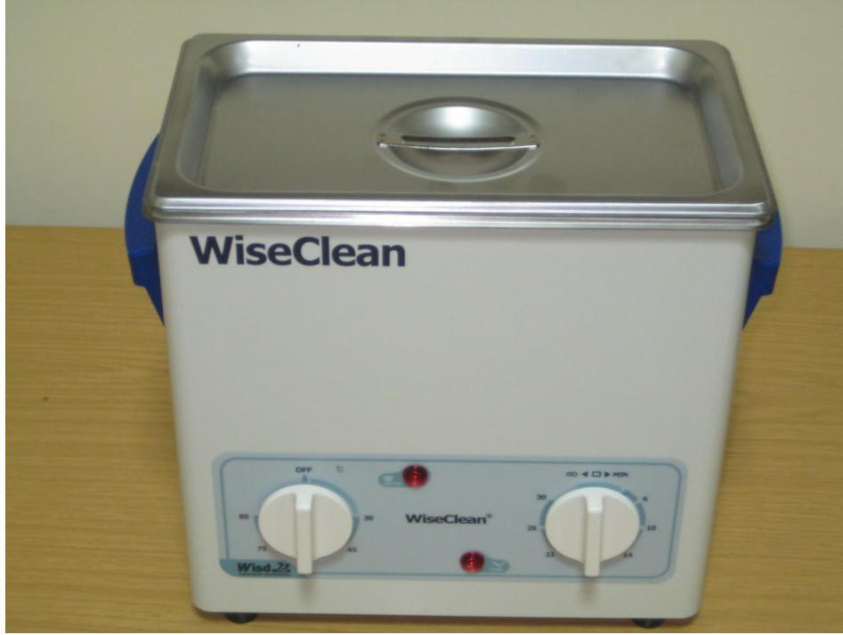
Şekil 2.9. Ultrasonik temizleme cihazı (Wise Clean)
