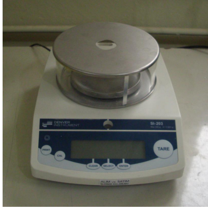
Şekil 2.12. Hassas tartım cihazı (DENVER INSTRUMENTS SI-203)
