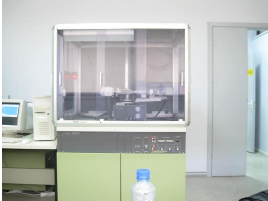
Şekil 2.34. Bilgisayar Kontrollü X-Işınları Difraktometresi (XRD) ( Rigaku RadB-DMAX II )
