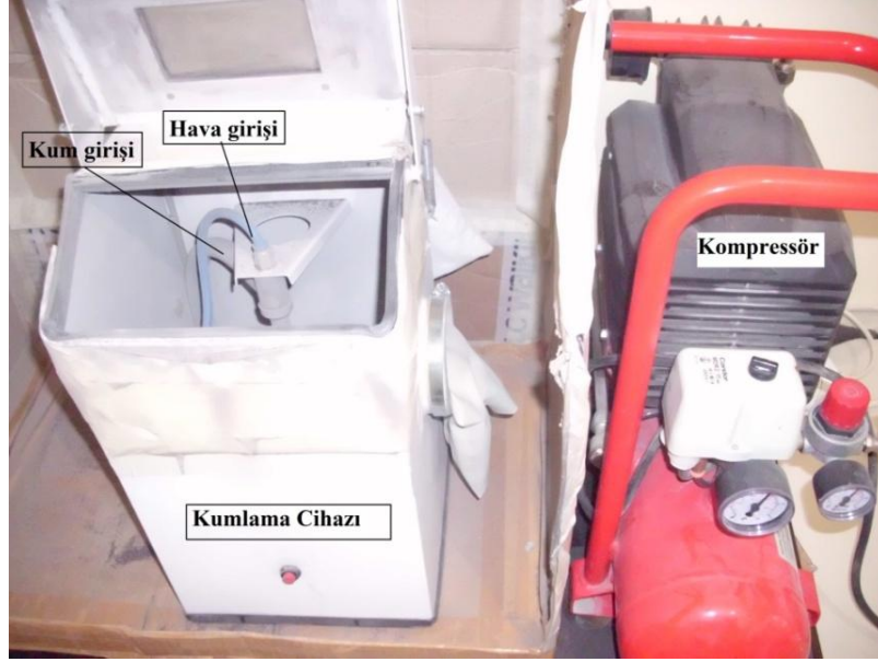
Şekil 2.8. Numune yüzeylerinin pürüzlendirildiği kumlama cihazı
