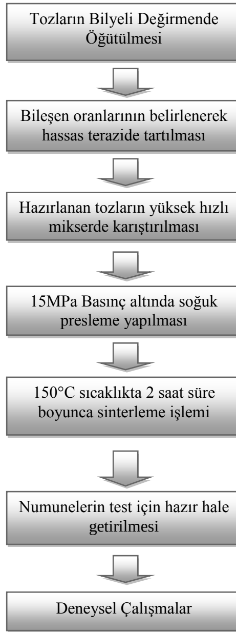
Şekil 7.19 Numunelerin üretim şeması
