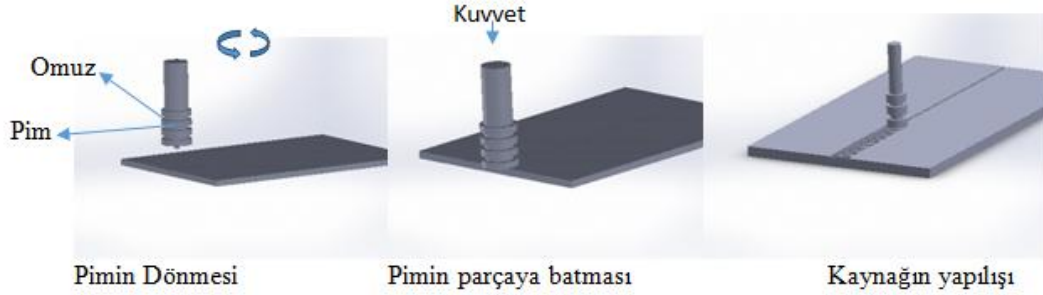
Şekil 3.7. Sürtünme karıştırma kaynağı yapım aşamaları
