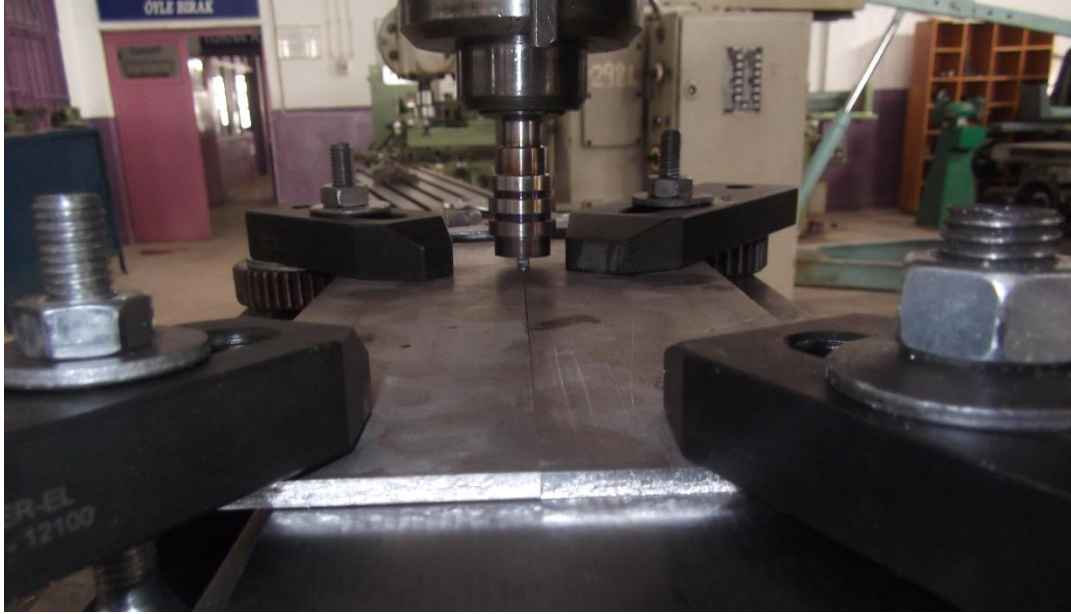
Şekil 3.6. Malzeme çiftinin freze tezgahına bağlama düzeneği
