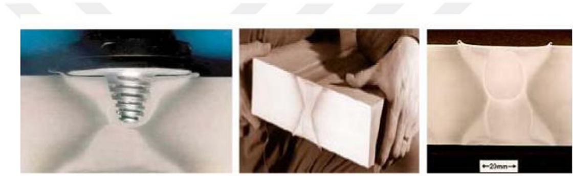
Şekil 1.8. 75 mm kalınlığındaki AA6082 T6 alaşımının kaynağında whorl™ takımını kullanılması, kaynağın bitmiş hali ve kaynak dikişinin görüntüsü [23].
