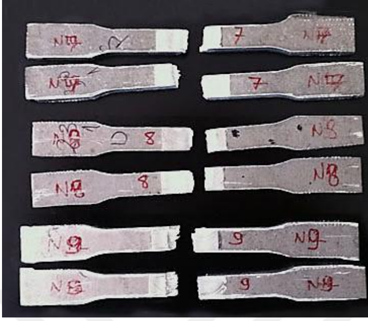
Şekil 4.48. N7, N8 ve N9 nolu numunelere ait makro kırık yüzey fotoğrafları
