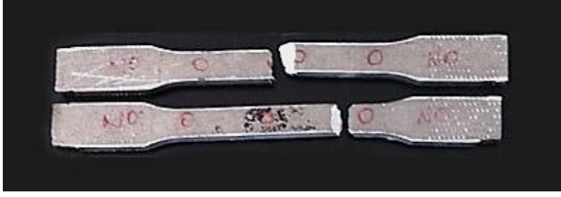
Şekil 4.36. AZ31B Mg alaşımına ait makro kırık yüzey fotoğrafı
