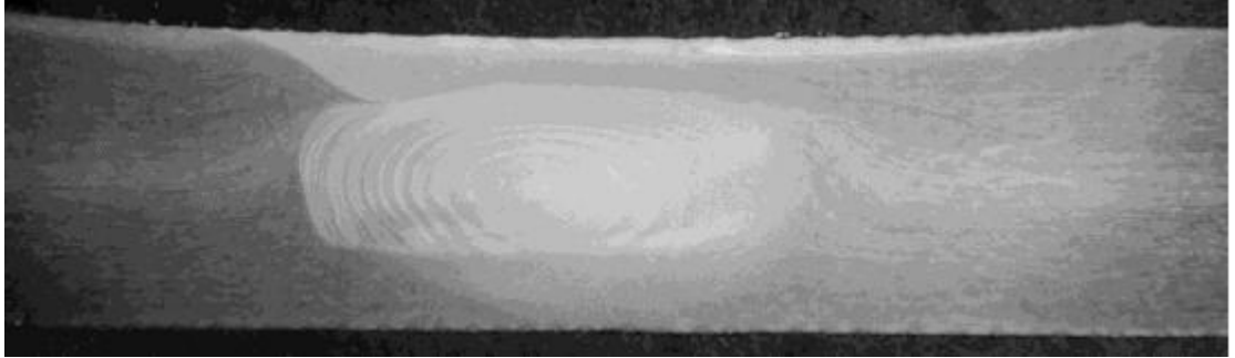
Şekil 1.17. Sürtünme karıştırma kaynağı yapılmış kaynağın kaynak bölgesinin kesiti [25].
