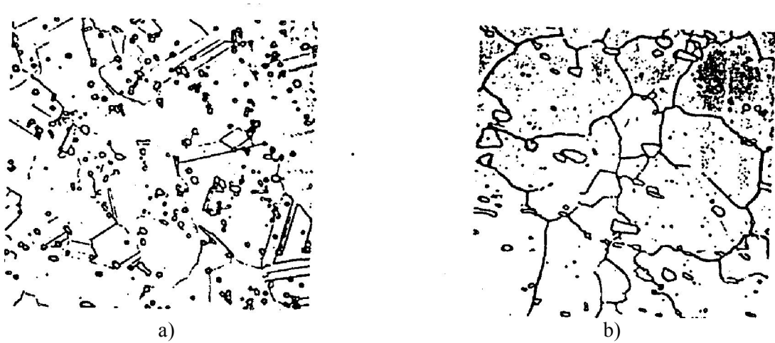
Şekil 3.14. S-816 alaşımının mikroyapısı, a) 1 Saat 1175°C'da solisyona alınmış ve suyla soğutulmuş S-816 alaşımı, b) Aynı alaşımının 16 Saat 760°C'da tavlandıktan sonra havada soğutulmuş mikroyapısı (Metals Handbook, 1985)
