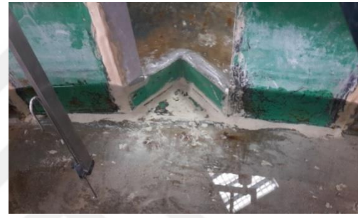
(d). 1/3 Kapalı Üçgen Labirent Yan Savak: \alpha = 90^\circ ve L = 25 cm
