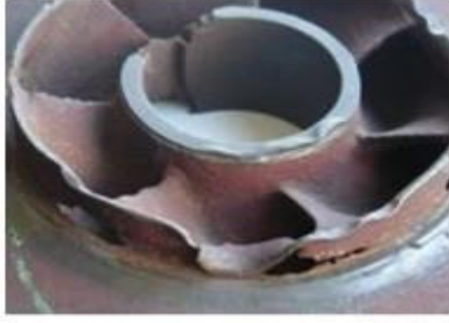
Şekil 4.10 Kavitasyon aşınmasına uğramış pompa
