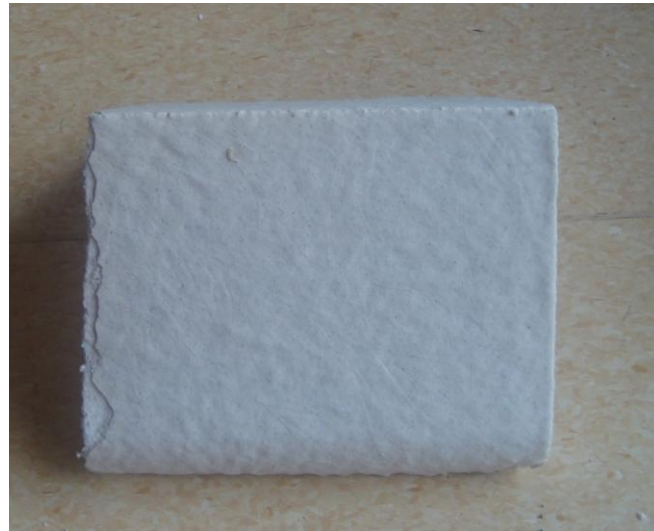
Resim 5.4. -10°C ile 0°C sıcaklıklarda antifiriz kullanılmadan hazırlanan malzemenin 48 saat sonraki durumu.
