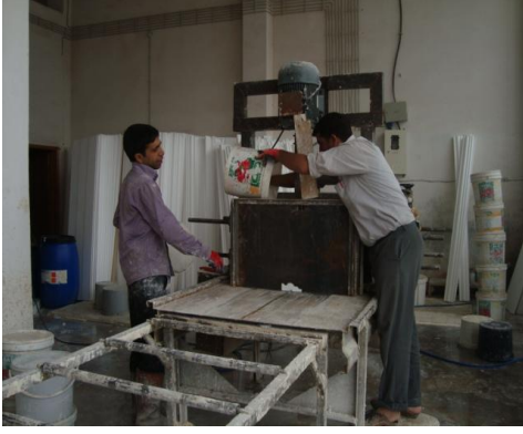
Resim 4.24. Söve Harcının, Harç Kaplama Kazanına Konulması [34].
