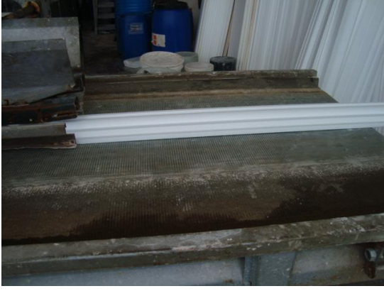
Resim 4.26. Kesilmiş EPS nin Sıvanmak Üzere Kaplama Kazanına Gönderilmesi [34].
