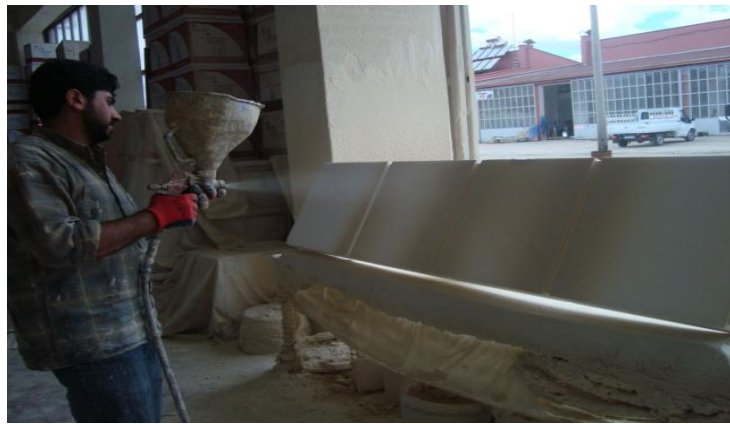
Resim 4.28. Püskürtme Yöntemi İle Sıvanan EPS [34].
