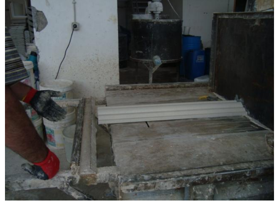
Resim 4.27. Sıvama İle Sıvanan EPS nin Makineden Çıkışı [34].
