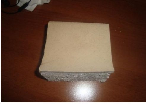
Resim 5. 1. Tablo 5. 5. de kullanılan malzemelerle hazırlanıp buzdolabında dondurulan söve.
