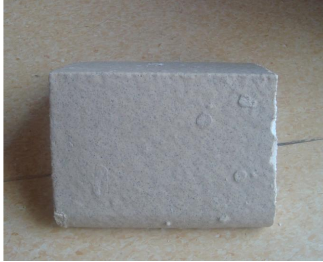
Resim 5. 3. -10°C ile 0°C sıcaklıklarda antifiriz kullanılan malzemenin 48 saat sonraki durumu.
