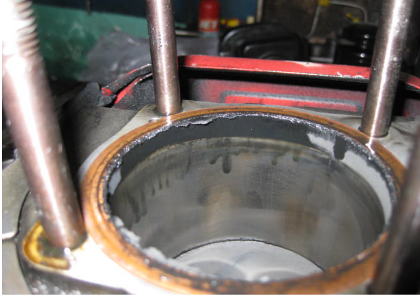
Şekil 12.23. DKLY100 yakıtı ile 50 saatlik çalışma sonunda silindir üst kısmının durumu
