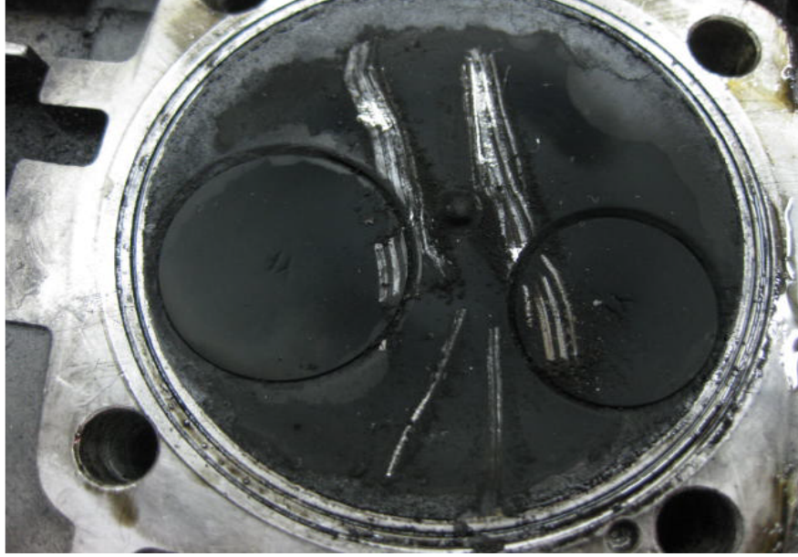
Şekil 12.16. DY yakıtı ile 50 saatlik çalışma sonunda üst kapağın durumu
