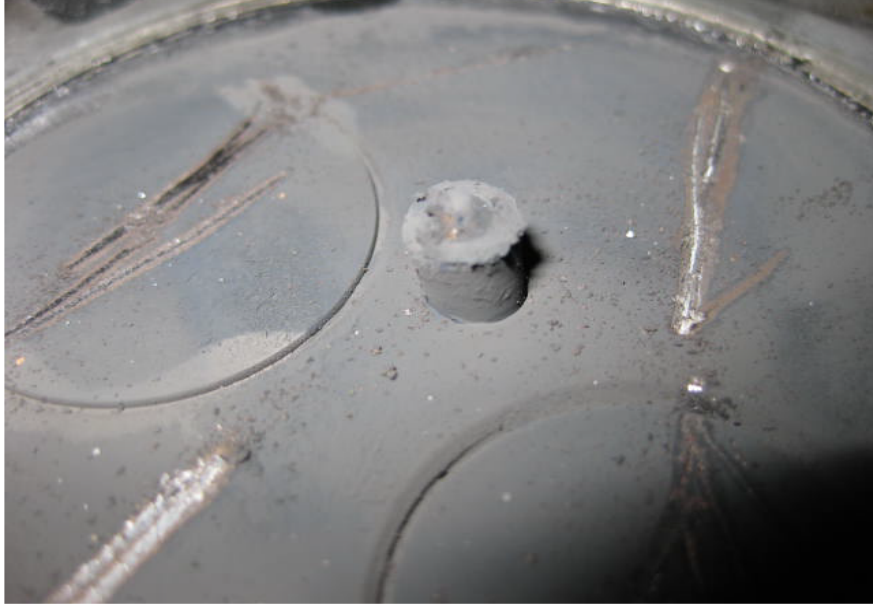
Şekil 12.19. DKLY100 ile 50 saatlik çalışma sonunda enjektör ucunun durumu
