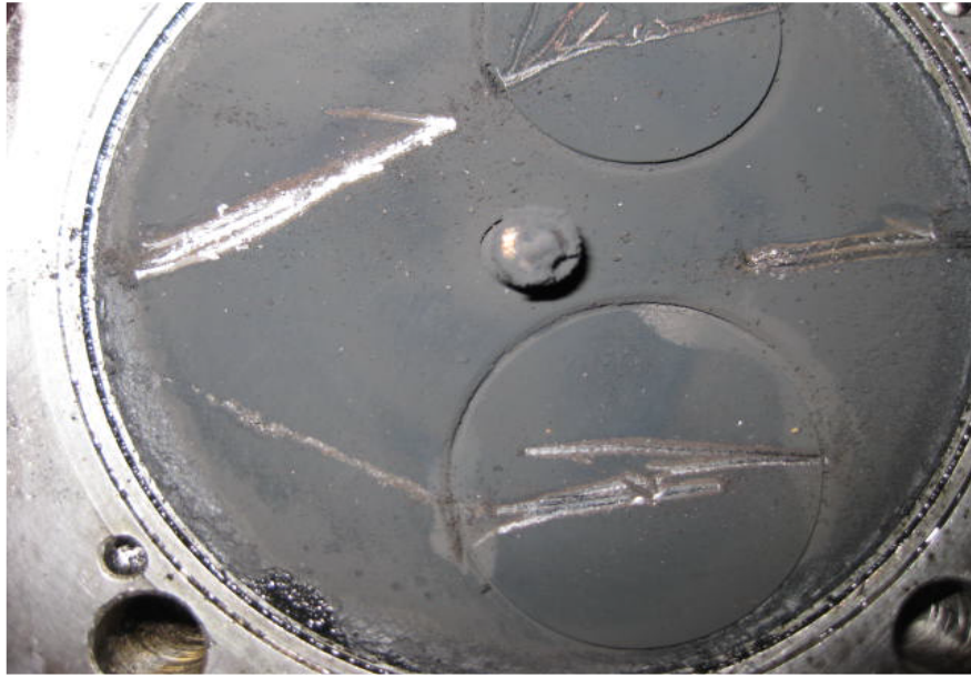
Şekil 12.17. DKLY100 yakıtı ile 50 saatlik çalışma sonunda üst kapağın durumu
