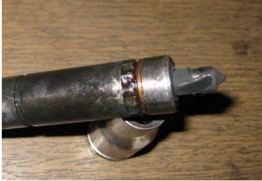
Şekil 12.18. DY yakıtı ile 50 saatlik çalışma sonunda enjektör ucunun durumu
