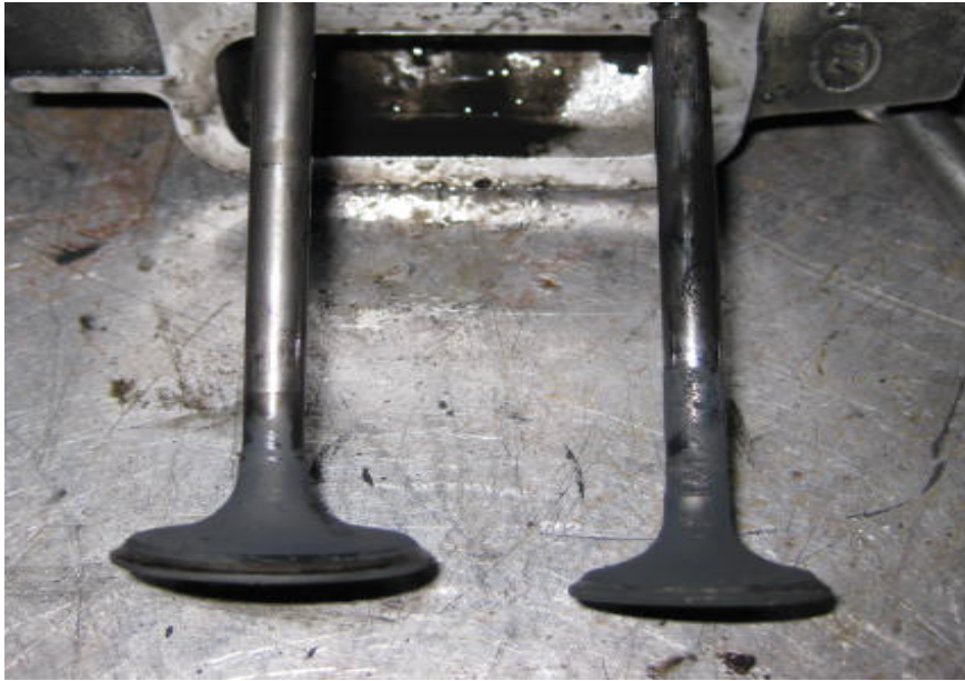
Şekil 12.15. DKLY100 yakıtı ile 50 saatlik çalışma sonunda supapların durumu
