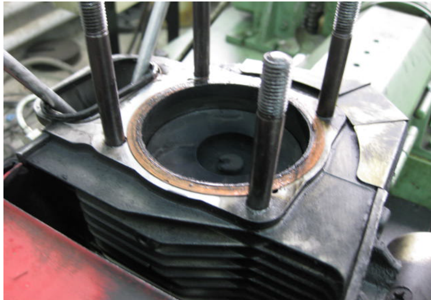
Şekil 12.22. DY yakıtı ile 50 saatlik çalışma sonunda silindir üst kısmının durumu
