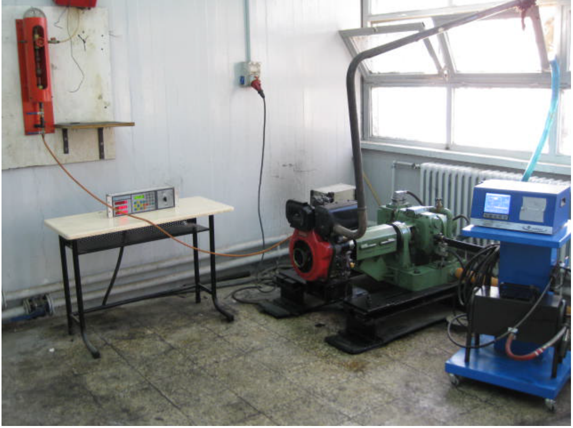
Şekil 8.5. Deneylerde kullanılan BT-140 model hidrolik dinamometre
