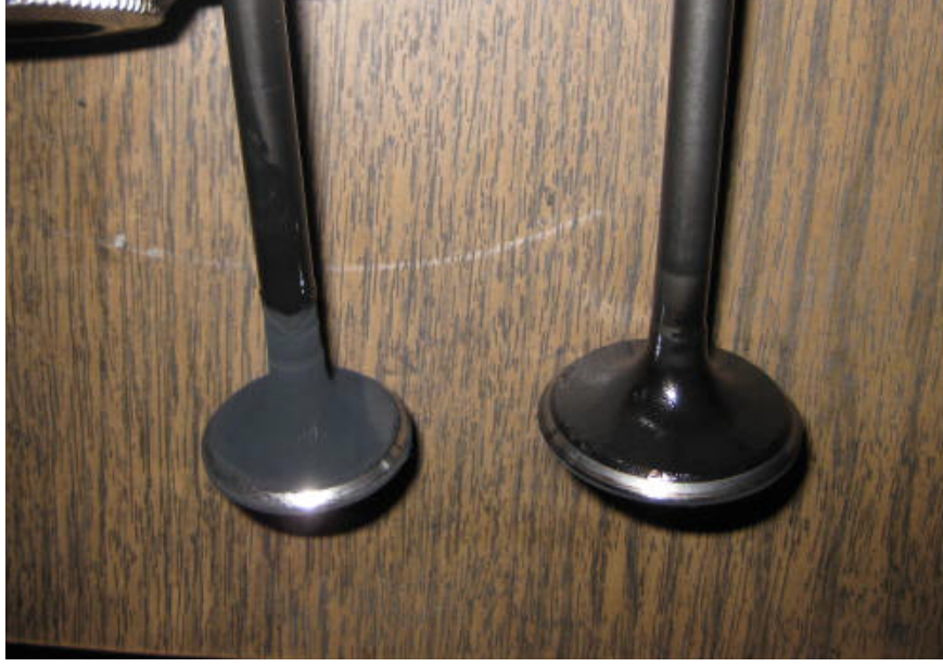
Şekil 12.14. DY yakıtı ile 50 saatlik çalışma sonunda supapların durumu
