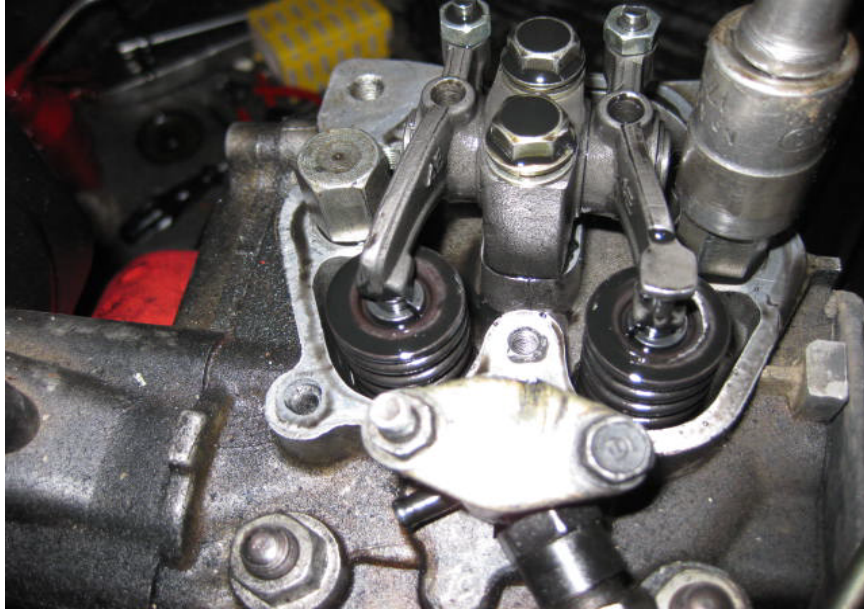
Şekil 12.24. DKLY100 yakıtı ile 50 saatlik çalışma sonunda külbütör ve iteçeklerin durumu
