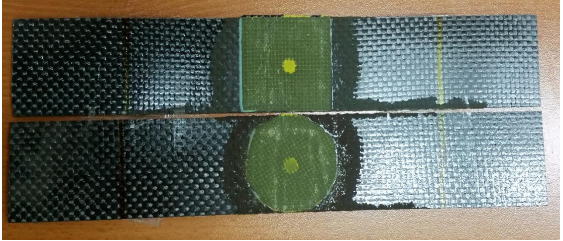
Şekil 6.5. Hazır yama-film yapıştırıcı ile tamirâtı yapılmış karbon fiber takviyeli test numunelerinin görünümü
