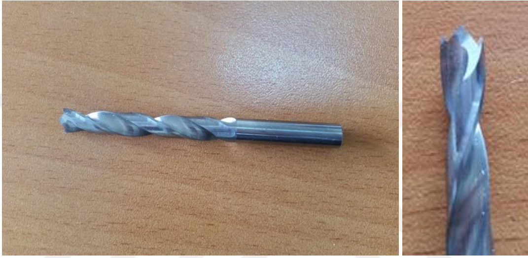
Şekil 6.1. Kompozit plakaların hasarlandırılması için kullanılmış olan matkap ucu (Ultra Tool)
