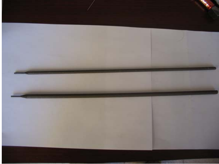
Şekil 5,1. Çalışmada üretilen 5.20 mm (Elektrot I) ve 6.65 mm (Elektrot II) örtü çapına sahip elektrotlar.
