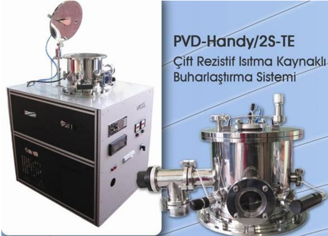
Şekil 7.2 Termal buharlaştırma için kullanılan PVD-HANDY/2S-TE (Vaksis Şirketi) termal buharlaştırma sistemi
