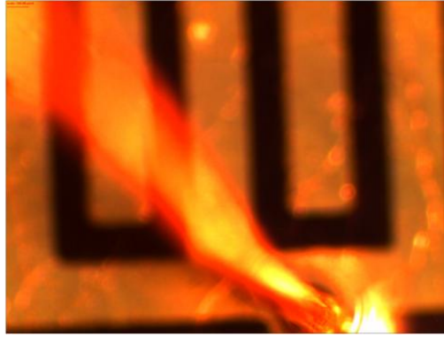
Şekil 7.8 n-Si/SiO 2 /pentasen OFET'inin optik mikroskobu görüntüsü
