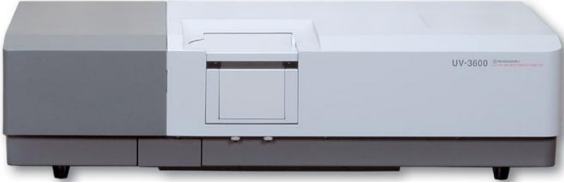
Şekil 7.1 Optik ölçümler için kullanılan UV-Vis Shimadzu 3600 spektrometresi
