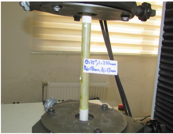
Şekil 5.85. 250mm uzunluktaki camepoksi numuneleri; a) burulma öncesi, b) burulma sonrası
