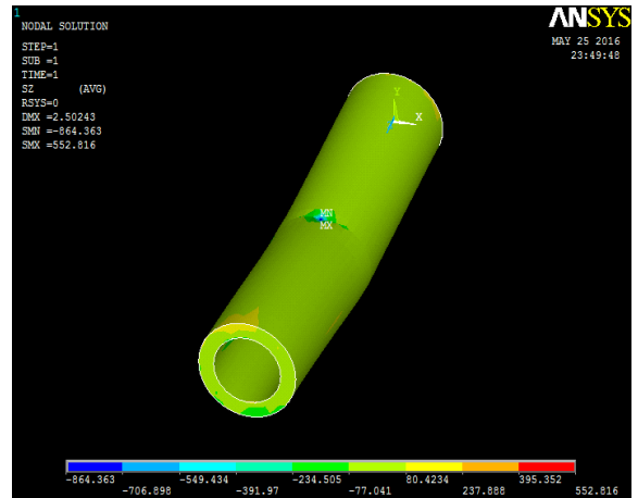
Şekil 5.72. \theta=45^\circ , D_i=12\text{mm} , D_d=17\text{mm} , L=80\text{mm} boyutundaki Karbon/epoksi'nin ANSYS'te uç nokta eğme gerilmesi altındaki çözümü
