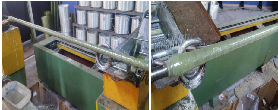
Şekil 5.9. Filaman sarma yöntemi ile cam/epoksi, karbon/epoksi ve kevlar/epoksi içi boş dairesel kompozit millerin imal edilmesi
