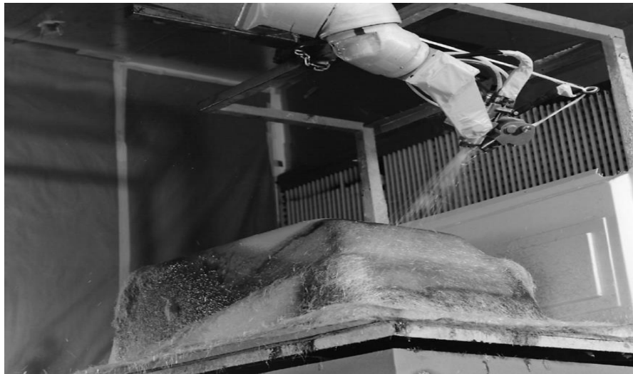
Şekil 3.26. Püskürtme yönteminin şematik gösterimi
