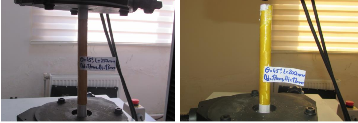
Şekil 5.87. 250mm uzunluktaki kevlar/epoksi numuneleri; a) burulma öncesi, b) burulma sonrası
