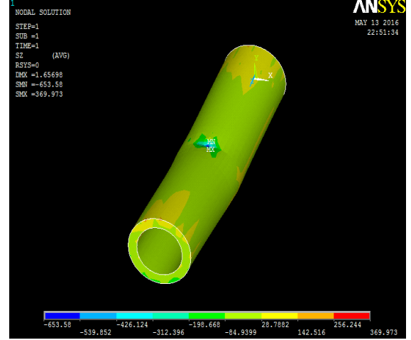
Şekil 5.70. \theta=45^\circ , D_i=12\text{mm} , D_d=17\text{mm} , L=80\text{mm} boyutundaki Cam/epoksi'nin ANSYS'te uç nokta eğme gerilmesi altındaki çözümü
