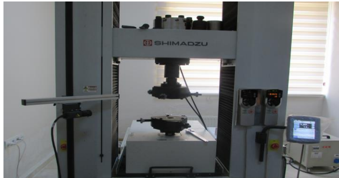
Şekil 5.83. Burulma test düzeneği
