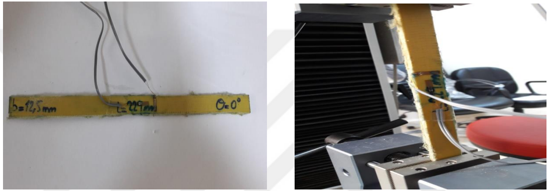
Şekil 5.3. Fiber takviye doğrultusunda çekme test düzeneğine bağlanılan [0^\circ]_3 tabaka dizilimine sahip kevlar/epoksi numunesi
