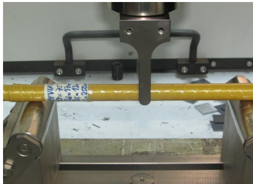
Şekil 5.14. Kevlar/epoksi numunelerin 3 nokta eğme yükü altındaki durumları; a) deney öncesi b) deney sonrası
