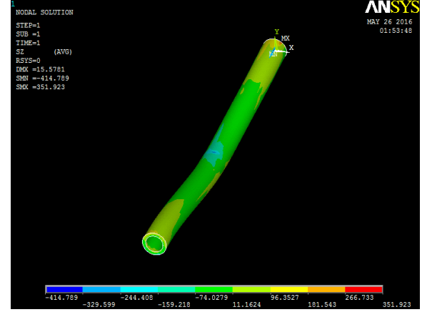
Şekil 5.79. \theta=45^\circ , D_i=12\text{mm} , D_d=17\text{mm} , L=250\text{mm} boyutundaki Karbon/epoksi'nin ANSYS'te üç nokta eğme gerilmesi altındaki çözümü
