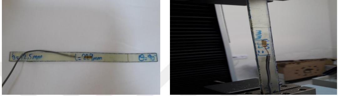
Şekil 5.4. Fiber takviye dik doğrultusunda çekme test düzeneğine bağlanan [90^\circ]_3 tabaka dizilimine sahip cam/epoksi numunesi
