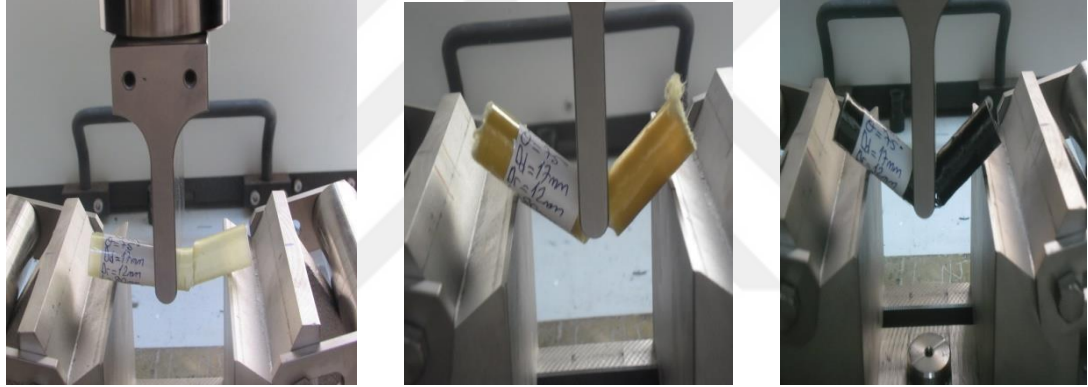
Şekil 5.16. Numunelerin 3 nokta eğme yükü altındaki durumları: a) cam/epoksi, b) kevlar/epoksi, c) karbon/epoksi
