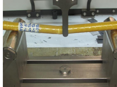
Şekil 5.14. Kevlar/epoksi numunelerin 3 nokta eğme yükü altındaki durumları; a) deney öncesi b) deney sonrası
