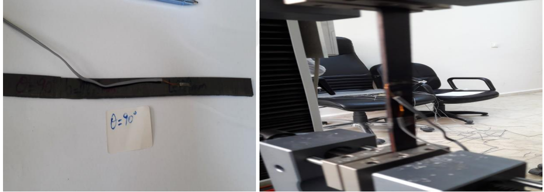
Şekil 5.5. Fiber takviye dik doğrultusunda çekme test düzeneğine bağlanan [90^\circ]_3 tabaka dizilimine sahip karbon/epoksi numunesi
