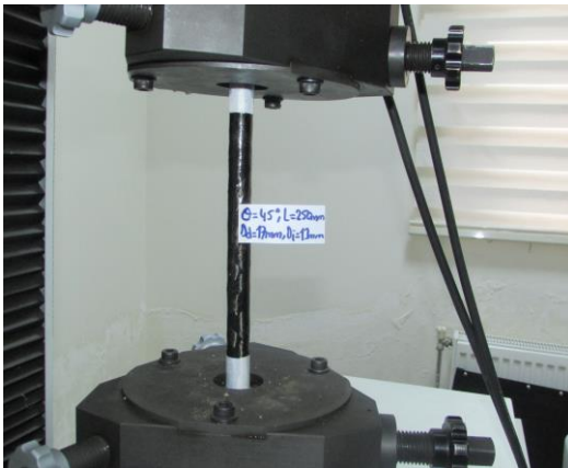
Şekil 5.86. 250mm uzunluktaki karbon/epoksi numuneleri; a) burulma öncesi, b) burulma sonrası
