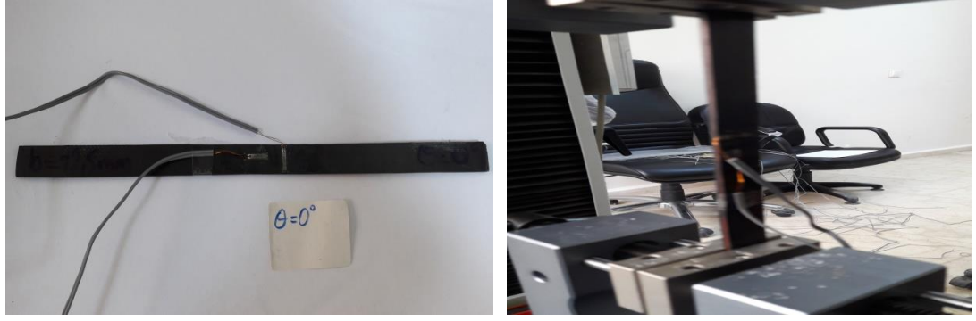
Şekil 5.2. Fiber takviye doğrultusunda çekme test düzeneğine bağlanılan [0^\circ]_3 tabaka dizilimine sahip karbon/epoksi numunesi
