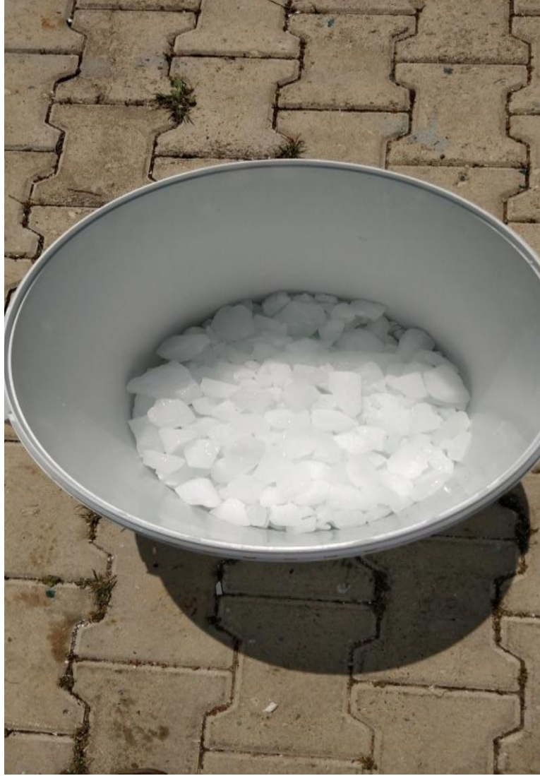
Şekil 2.24. Faz değıştiren malzemenin katı hali
