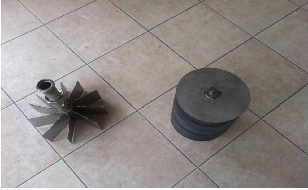
Şekil 2.7. Isı borusunun alt ve üst kısmı ayrılmış bir şekilde
