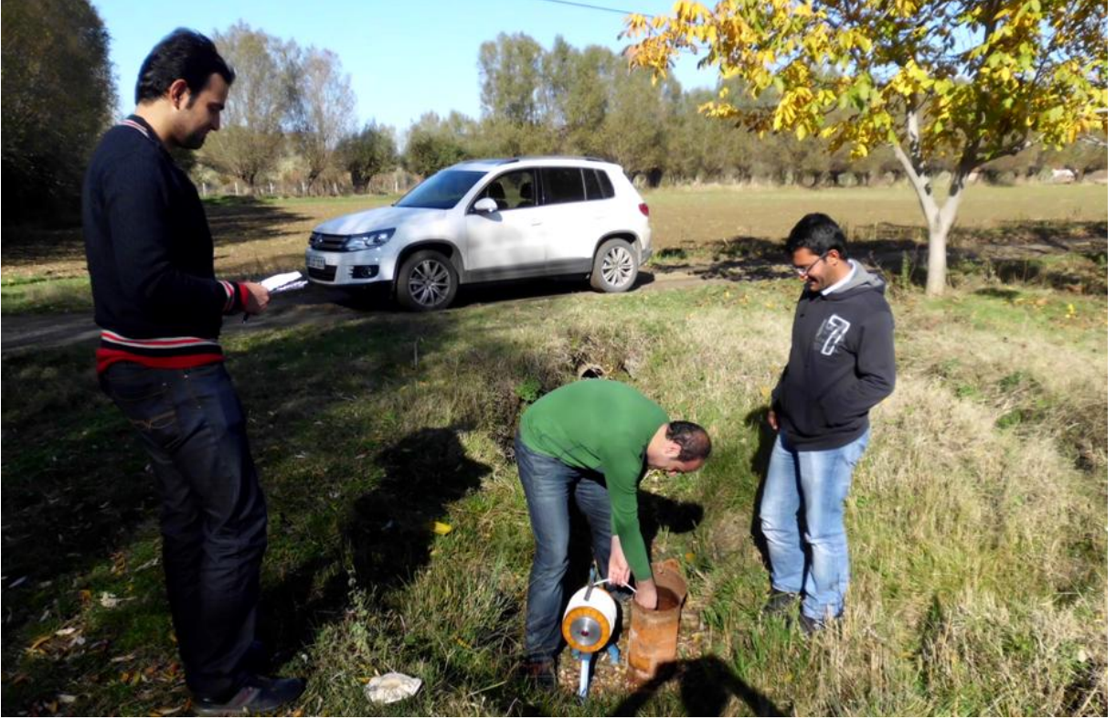
Şekil 3.10. Kuyularda statik su seviyesi ölçümü (Koordinat: 525361 - 4256837).
