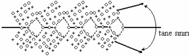
Şekil 2.18. Bir tane sınırı yapısının şematik gösterimi [32]
