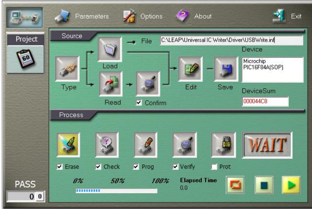
Resim 5.10. LEAPER 48 programlayıcıda komutların mikrokontrolöre yazdırılması işlemi
