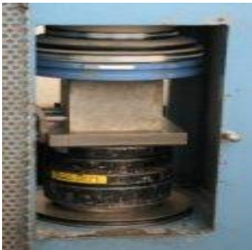
Şekil 2.4. Beton basınç dayanımı test cihazı
