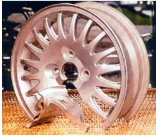
Şekil2.15. Sürtünme Karıştırma Kaynak Yöntemi Kullanılarak Üretilmiş Tekerlek Jant Örneği
