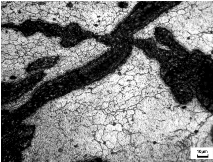
Şekil 4.13. 350 dev/dak'da birleştirilen numunedeki ITAB optik fotoğrafı
