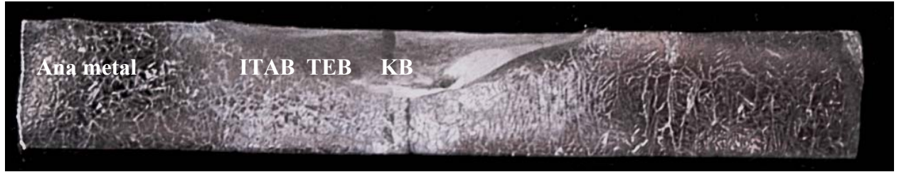
Şekil4.4. Kaynaklı bağlantılarda oluşan bölgeler. a. 350 d/d, b. 450 d/d, c. 550 d/d
