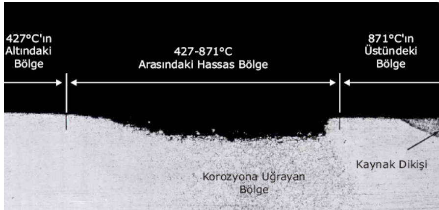
Şekil-2.6. Krom Karbür Çökmesi Sonucu Hassas Bölgede Oluşan Korozyon (ASM Committee, 1998)
