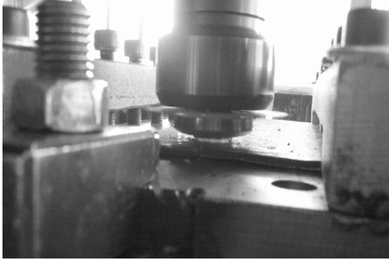
Şekil 3.6. Sürtünme sıcaklığının oluşumu.
