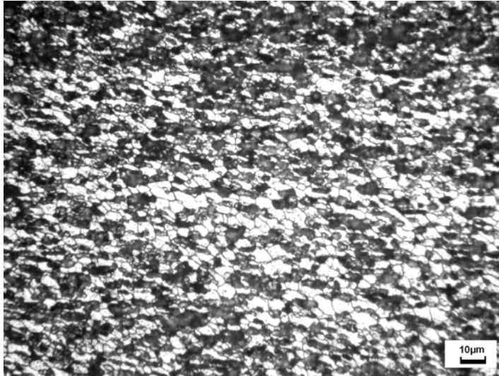
Şekil 4.11. 350 dev/dak'da birleştirilen numunenin karışım bölgesi arka kısım optik fotoğrafı
