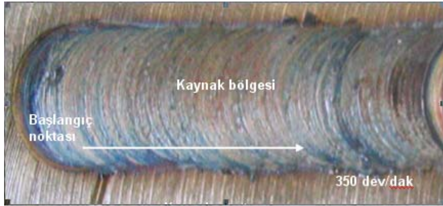
Şekil 4.9. 350dev/ dak.'da birleştirilen numunenin kaynak dikişi fotoğrafı
