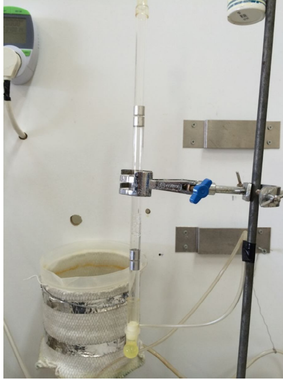
Şekil 6.7. Sabun Köpüğü Kolonu
