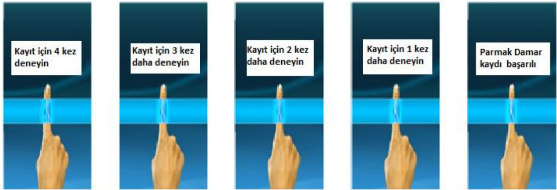
Şekil 29. KfV-100 Cihazının Parmak Damar Haritasına Göre Şifre Oluşturma Süreci
