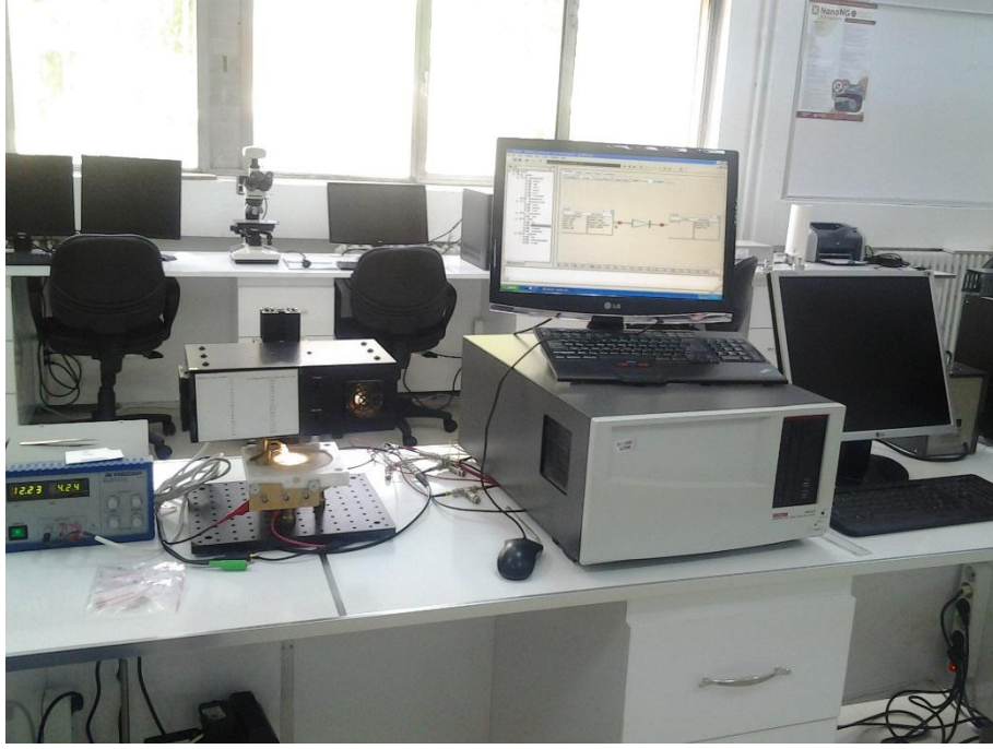
Şekil 5.17. Al/p-Si/MB+GO/Au diyotlarının I-V ve C-V ölçümleri için kullanılan deney düzeneği
