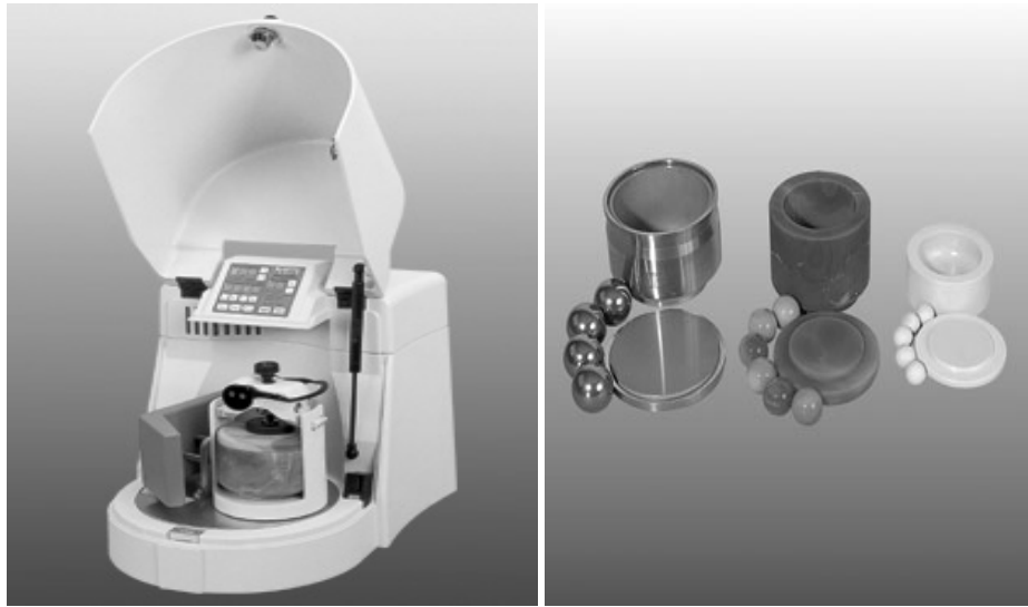
Şekil 2.6. Planeter bilyeli öğütücü ve öğütme kapları [15]
