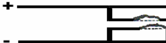
Şekil 3.5. Elektrik Ark erozyonunun Şematik Gösterimi [17]
