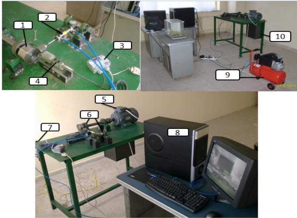
Şekil 9.10. Deneylerde kullanılan pnömatik tip aşınma cihazının elemanları
