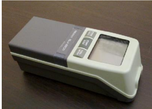
Şekil 9.8. Yüzey pürüzlülük ölçme cihazı (Mitutoyo SJ-201)
