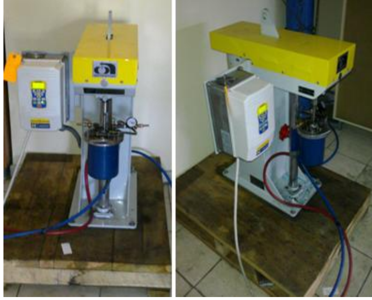
Şekil 9.3. Deneylerde kullanılan atritör (öğütme) cihazı
