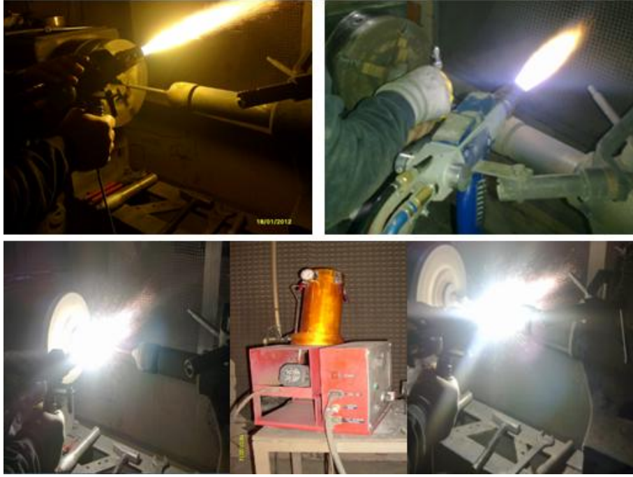
Şekil 9.6. Alevle püskürtme tekniği ile gerçekleştirilen kaplama uygulamaları
