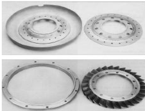
Şekil 3.1. Inconel MA 754’den yapılmış bazı gaz türbini parçaları [41].
