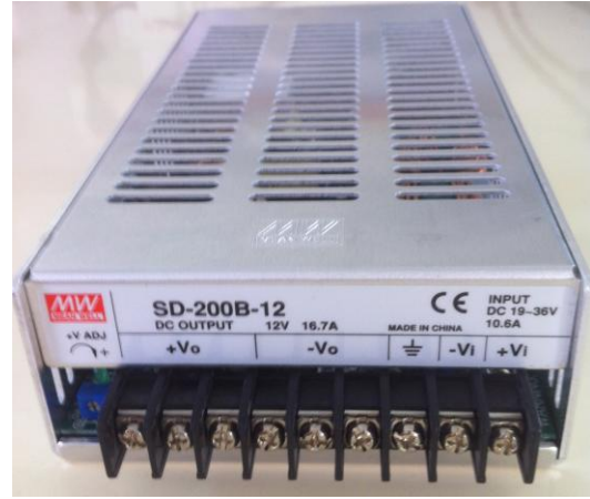
Şekil 5.20. 200 W alçaltıcı konverter
