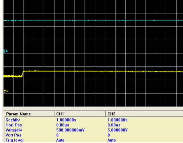
Şekil 6.13. 15 W’lık yükün devreden çıkma anındaki FC ve konverter gerilimi
