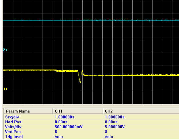
Şekil 6.8. 15 W'lık yükün devreye alınma anındaki FC ve konverter gerilimi
