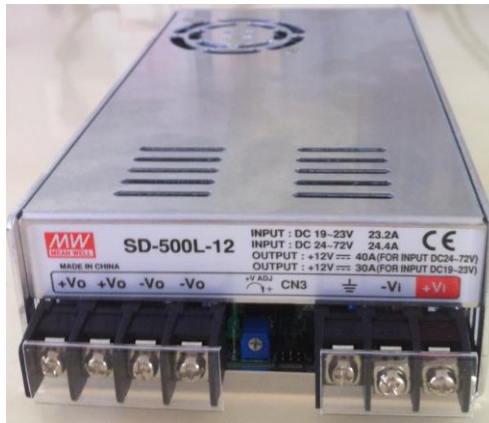
Şekil 5.21. Güneş pili için kullanılan alçaltıcı konverter
