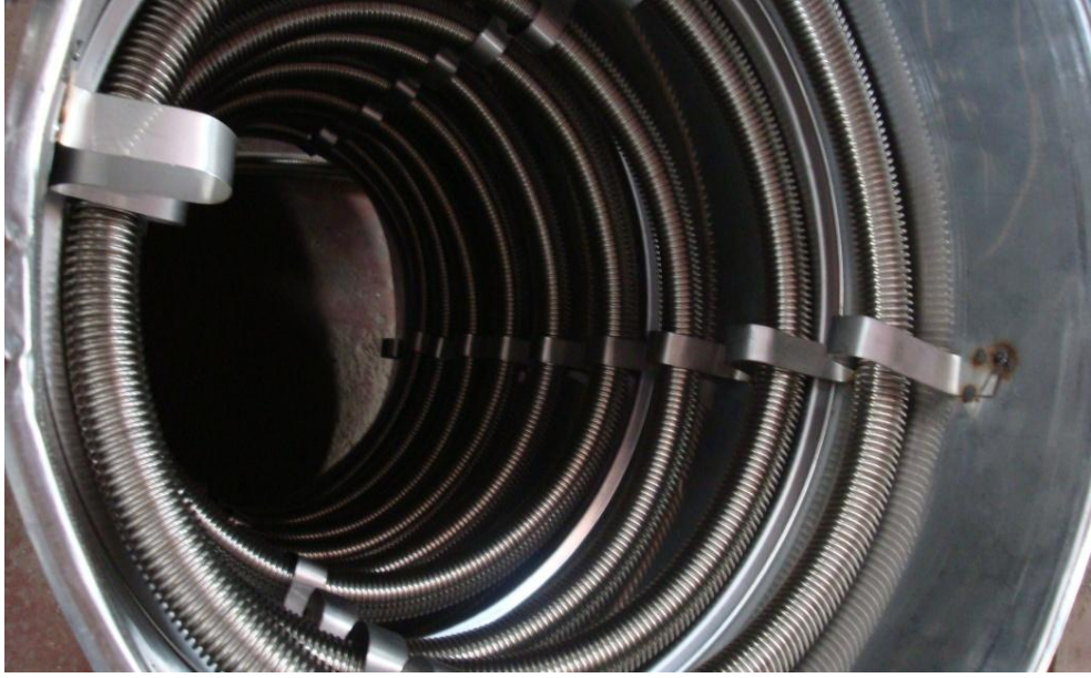
Şekil 2.3. Spiral boru yerleştirilmiş düşey sıcak su tankının üstten görünüşü.
