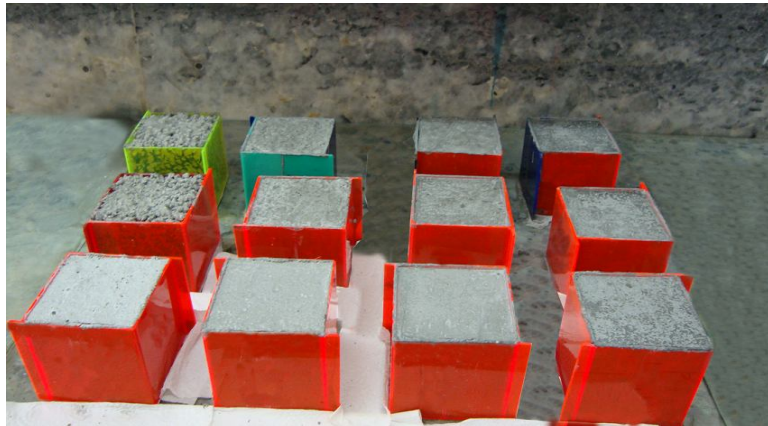
Şekil 5.1. Plastik kalıplara dökülmüş numuneler
