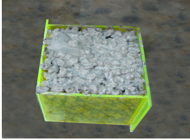
Şekil 5.4. Mekanik deneyler için 0-4, 4-8, 8-12 mm çaplı bimsler ile hazırlanmış deney numuneleri
