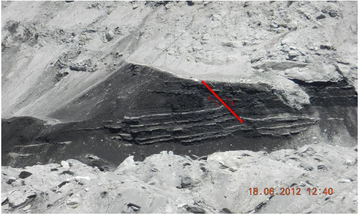
Şekil 6.1. Kömürlü seviyedeki faylanma (Bakış yönü-KB)
