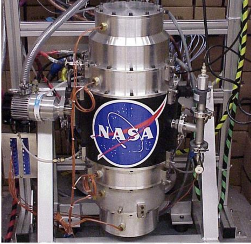
Şekil 3.9 NASA tarafından geliştirilen mekanik enerji depolama birimi
