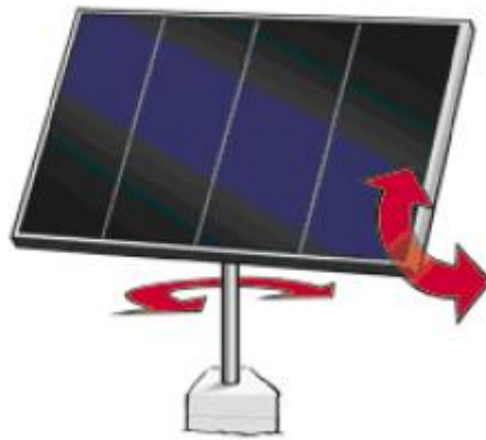
Şekil 2.6. Güneş panellerinin çift eksenli olarak konumlandırılması
