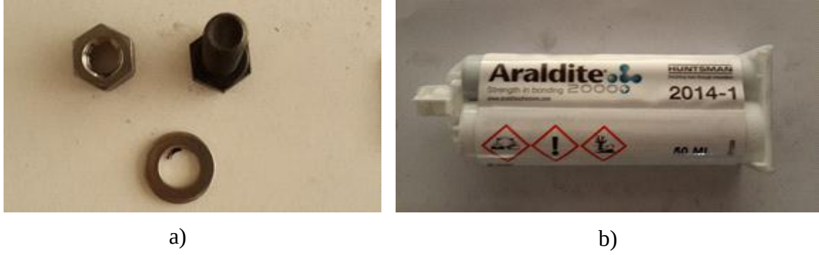
Şekil 4.4 Karbon fiber kompozit malzemelerin ve cam fiber kompozit malzemelerin birleştirilmesinde kullanılan malzemeler; a) St37 çelik civata, somun ve pul, b) Epoksi yapıştırıcı
