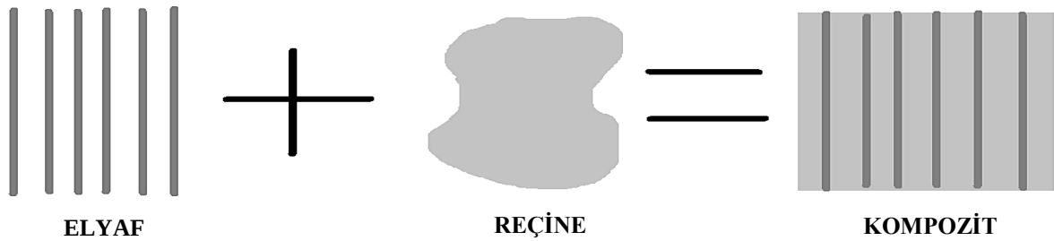
Şekil 3.1 Kompozit bir yapının meydana gelmesini sağlayan temel elemanlar [42].
