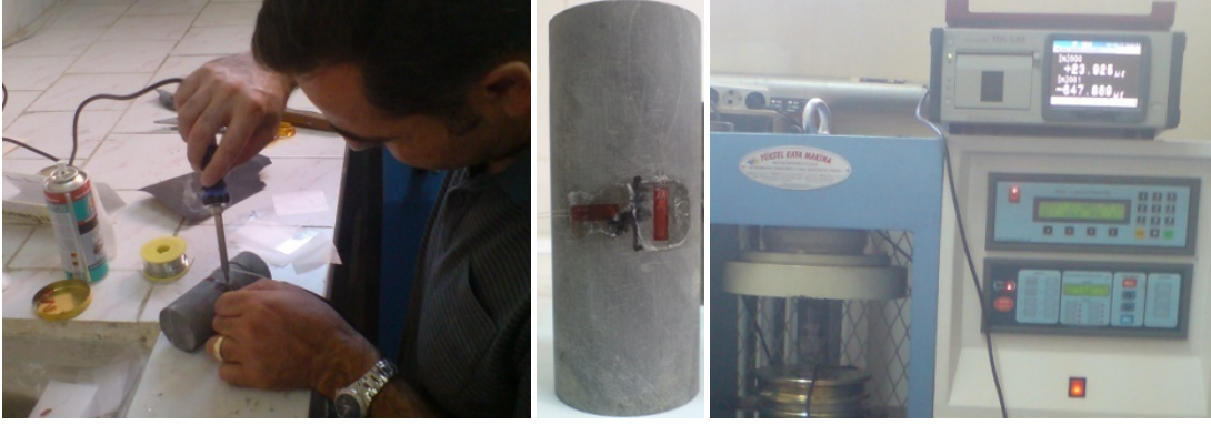
Şekil 4.28. Elastisite modülü deney düzeneği ve karot örneğinin hazırlanması.
