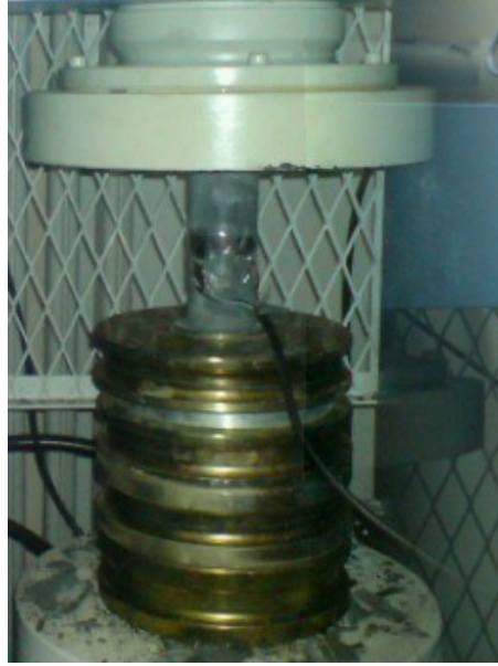
Şekil 4.23. Silttaşlarında yapılan tek eksenli sıkışma dayanımı deneyi
