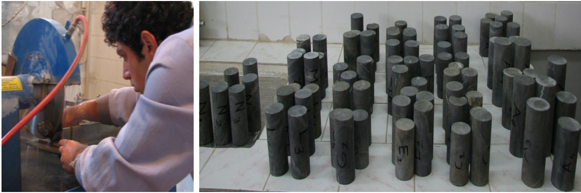
Şekil 4.22. Karot örneklerinin hazırlanması
