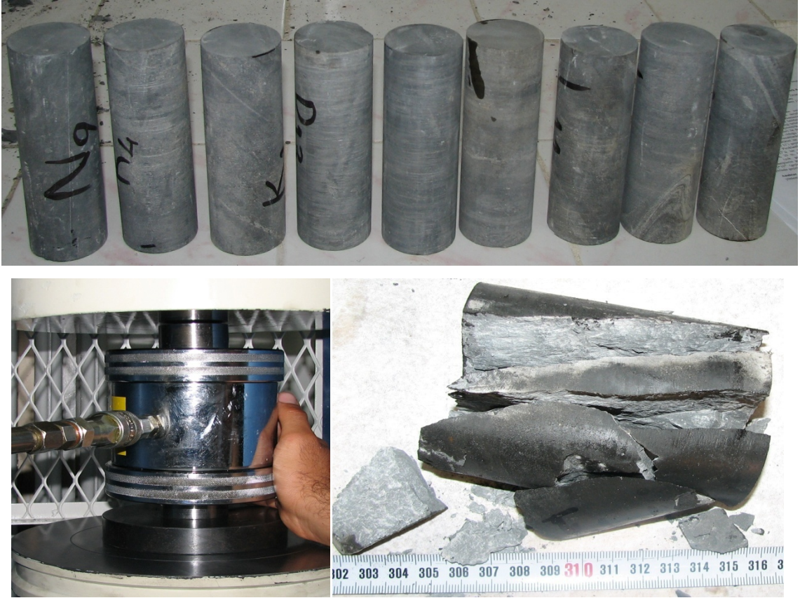
Şekil 4.24. Silttaşlarının üç eksenli gerilmede kullanılan örnekleri, Hoek hücresi ve yenilen bir karot
