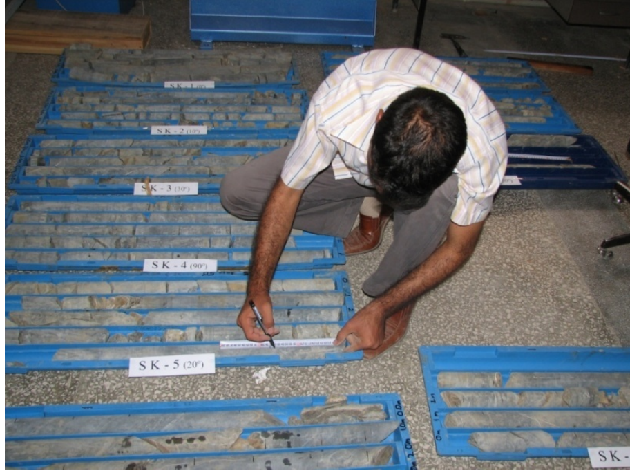
Şekil 4.10. Silttaşlarındaki sondajlardan alınan karotlardaki ölçümlerin yapılması.
